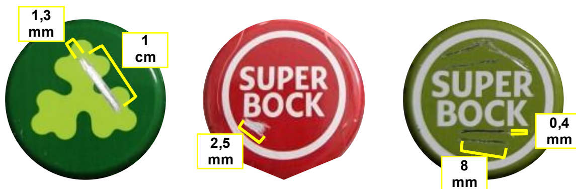
Figura A.1: Danos de cápsula definidos que o inspetor de pressão interna e imagem de cápsula deve rejeitar.
