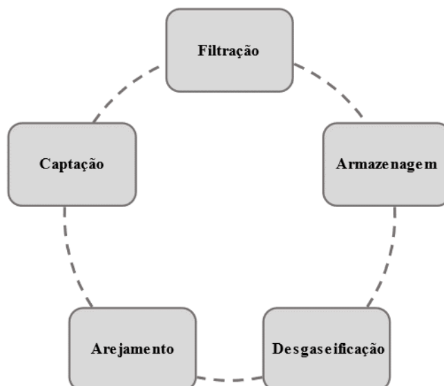
Figura 2.26: Esquema representativo de algumas etapas referentes ao processo produtivo de captação de Água das Pedras Regular.
