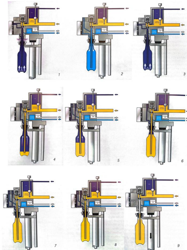
Figura 2.12: Esquema representativo do enchimento da cerveja [23].
