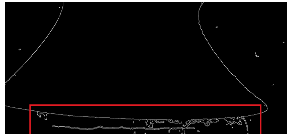
Figura 5.10: Exemplo do suporte a ser detetado pelo operador Canny na peça exemplo 2
