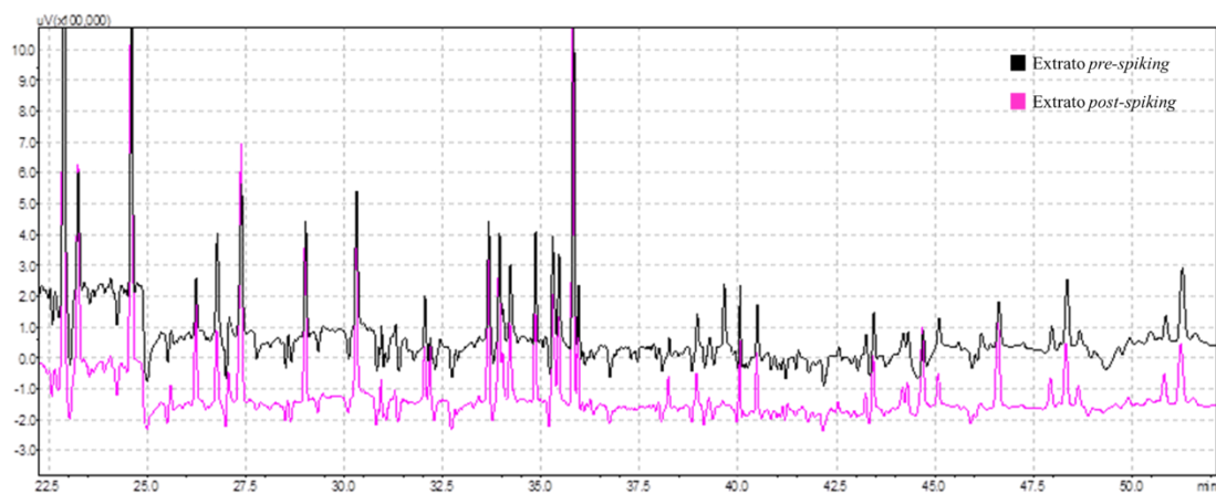
Figura 4.9 - Comparação entre cromatograma obtido pre-spiking (cor preta) e o cromatograma obtido post-spiking (cor rosa), teste 7.
