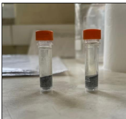
Figura 4.6- Extrato final obtido para a solução post-spiking (lado esquerdo) e pre-spiking (lado direito), do teste 3.
