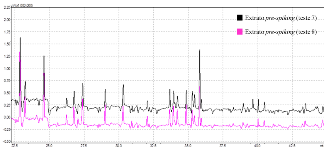
Figura 4.12 - Comparação entre cromatograma obtido pre-spiking para o teste 7 (cor preta) e o cromatograma obtido pre-spiking (cor rosa), teste 8.
