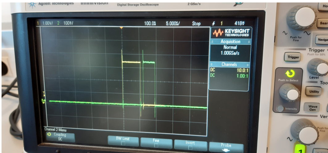
Figura 4.36: Execução da interrupção vs Conversão do ADC
