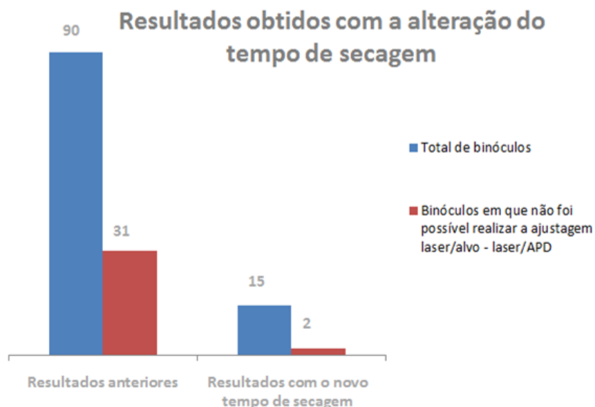
Figura 7.16: Alteração sofrida após aumento de 20 s na pré-secagem
