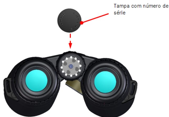
Figura 4.38: Colocação da tampa no botão de focagem
