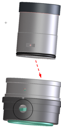
Figura 4.16: Colocação do ocular no kurventräger
