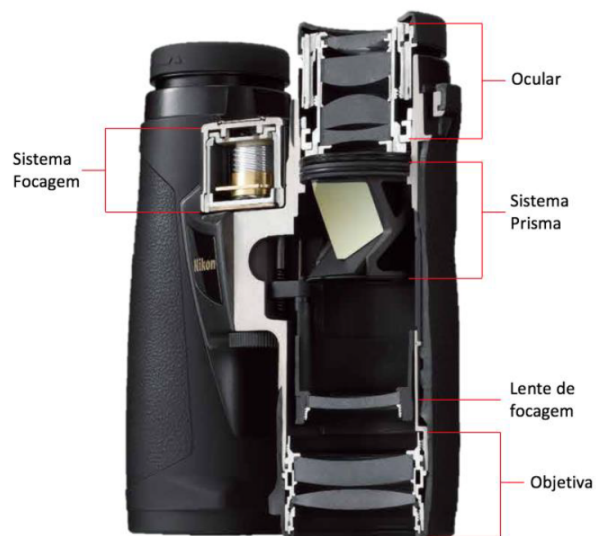
Figura 2.3: Caracterização de um binóculo.(Adotado e adaptado de (Nikon, 2013))
