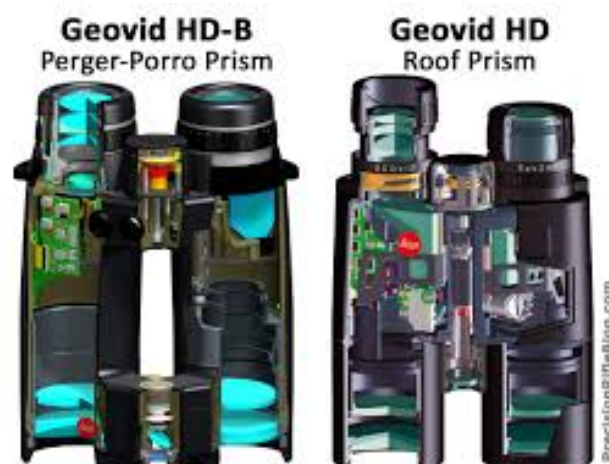
Figura 2.7: Sistema prismática de Perger-Porro . (Adotado e adaptado de (PrecisionRifle, 2013))
