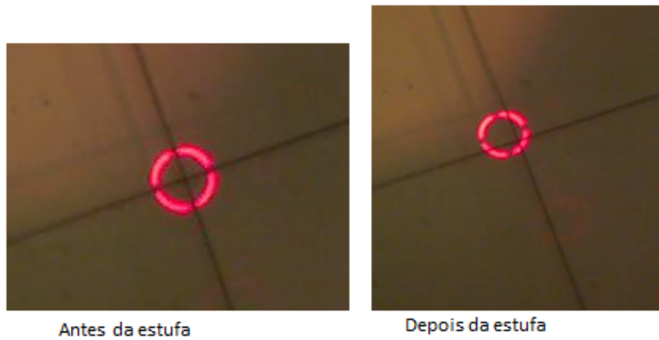
Figura 7.7: Elevada alteração na placa dos LEDs
