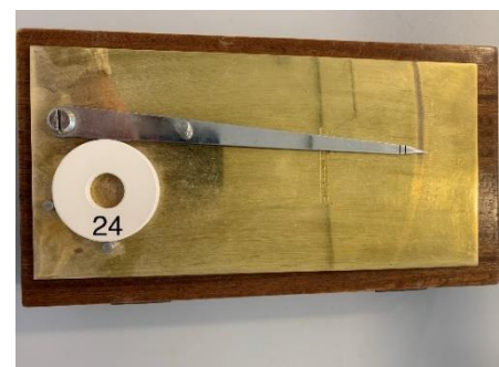
Figura 4-9 - Medição de um anel de buller para baixa temperatura.
