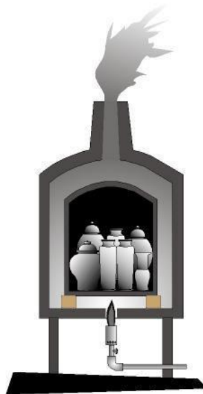
Figura 2-8 - Esquema de um forno de mufla.
