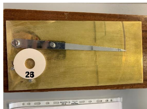
Figura 4-11 - Medição de um anel de buller para alta temperatura.
