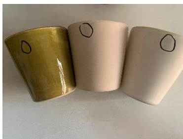
Figura 4-15 - Resultados obtidos para a pasta de faiança relativamente à resistência ao risco. 1) vidro brilhante; 2) engobe; 3) vidro mate.
