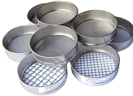
Figura 3-4 - Exemplo de peneiros com orifícios de diferente tamanho.
