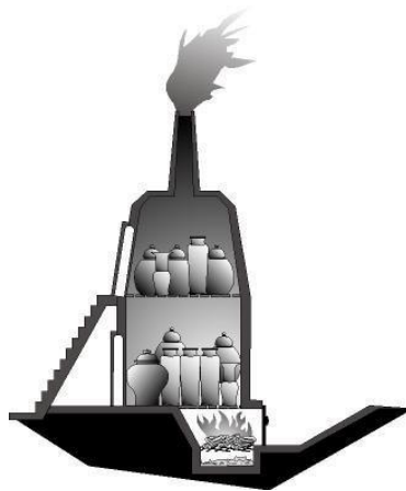
Figura 2-5 - Estrutura de um forno em garrafa.
