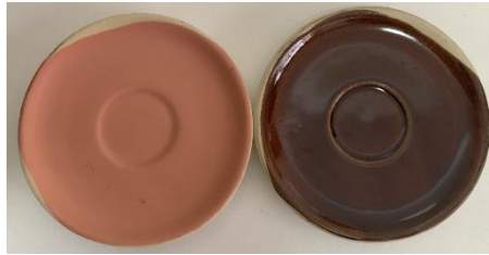
Figura 4-14 - Resultados físicos para choque térmico a 300 e 400°C.
