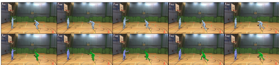
Figura C.3: Resultados visuais do HPS estimator com diferentes backbones num vídeo do repositório oficial do GLAMR [34]. Resultados com o backbone ResNet-34 (primeira linha). Resultados com o backbone HRNet-W48 (segunda linha). Este vídeo, de baixa resolução, destaca o aumento de precisão e redução de erro do backbone utilizado pelas consecutivas falhas na determinação das articulações dos humanos no backbone ResNet-34. Realça-se a orientação da mão esquerda do humano com ID 1 (roxo) no frame 57 ou falha no posicionamento das pernas do humano com ID 0 (verde) no frame 254. Melhor interpretação da figura a cores e ampliada.
