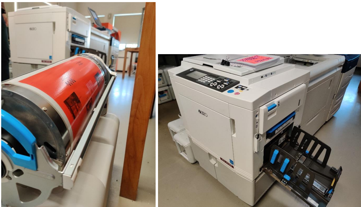
Figura 50 - Impressão risográfica de dois tambores utilizada (MF9350)
