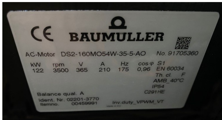
Figura 32 - Placa de especificações motor elétrico Baumüller
