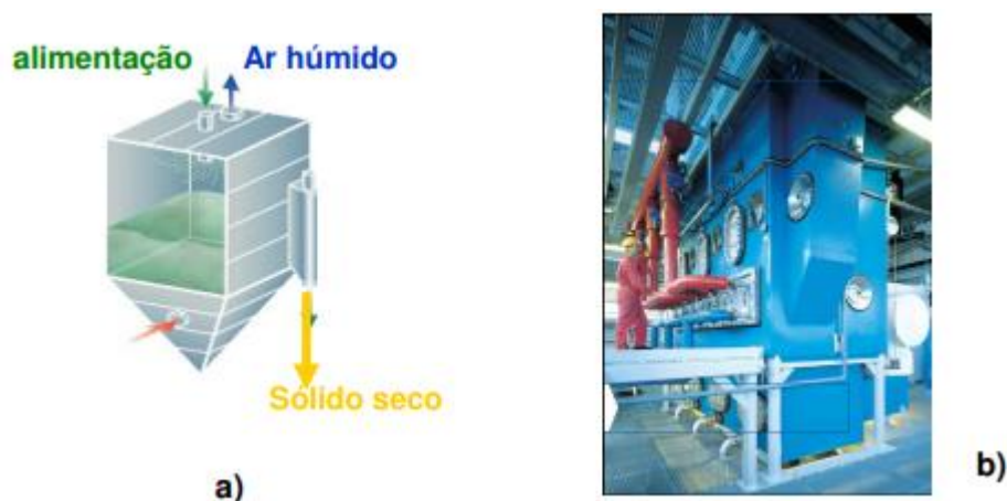
Figura 4.1.2. Secador de leito fluidizado a) esquema de funcionamento, b) fotografia do aspeto exterior [Marques, Paula & Silva, 2022]
