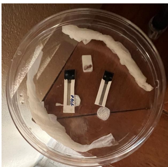
Figura 22. Bioelétrodos modificados durante o período de incubação com a enzima bilirrubina oxidase (BOx), sob atmosfera húmida e protegidos da luz.
