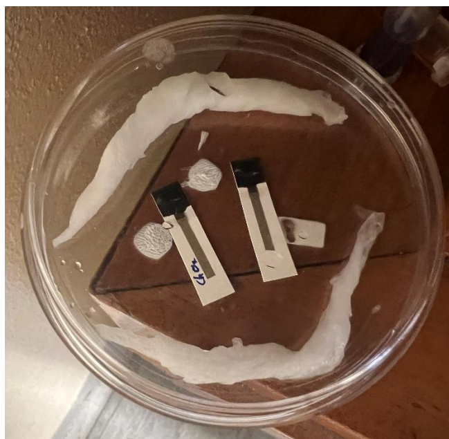
Figura 21. Bioelétrodos modificados durante o período de incubação com a enzima colesterol oxidase (ChOx), sob atmosfera húmida e protegidos da luz.
