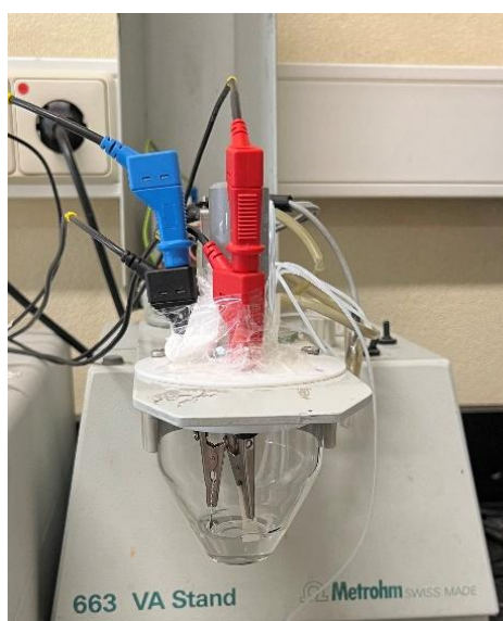
Figura 23. Representação esquemática da célula de biocombustível.
