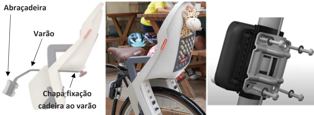
Figura 21: Exemplo de PBB com fixação ao seat tube.
