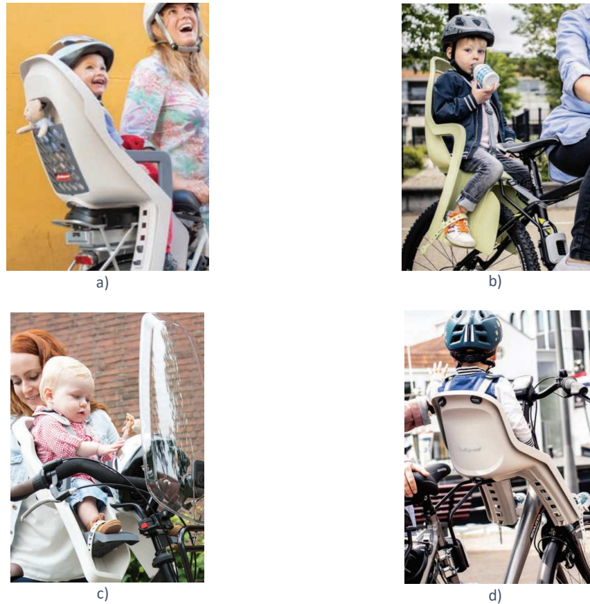
Figura 6: Exemplos de fixação da cadeira traseira ao carrier (a) e ao seat tube (b), e da cadeira frontal na zona da direção (c) e no seat tube (d) [31].
