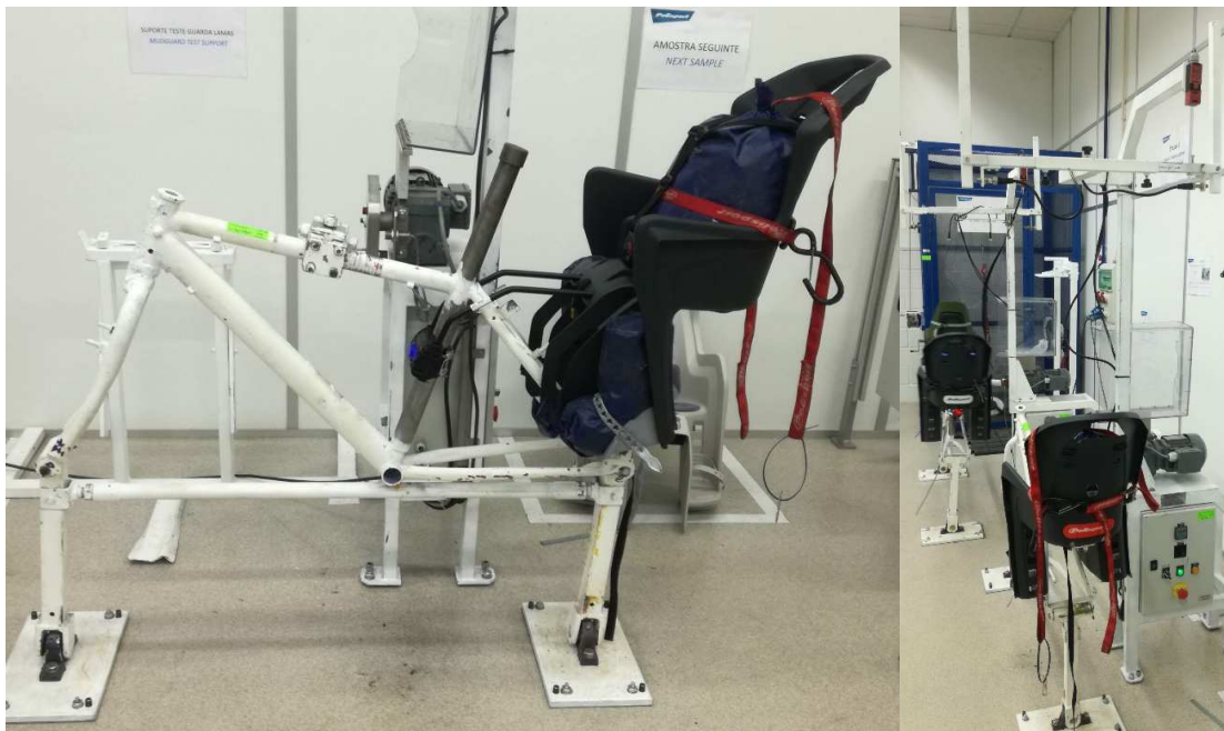
Figura 10: Equipamento usado pela Polisport para ensaio dinâmico lateral de acordo com EN 14344:2004 [32].
