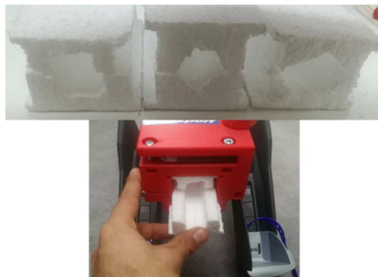
Figura 40: Casquilhos para adaptação da abraçadeira a vários diâmetros de seat tube .
