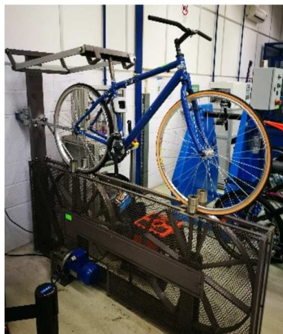
Figura 9: Equipamento usado pela Polisport para ensaio dinâmico vertical de acordo com EN 14344:2004 [32].
