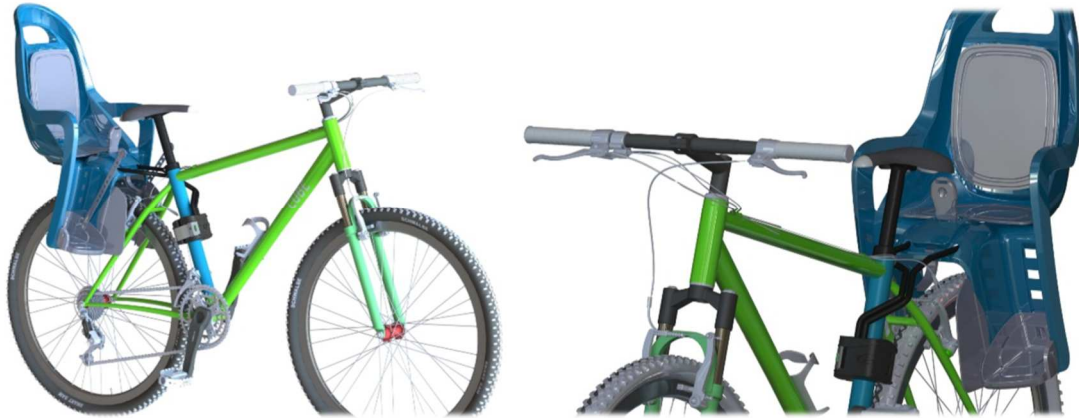
Figura 42: Representação do PBB com o novo sistema de fixação, montado numa bicicleta.
