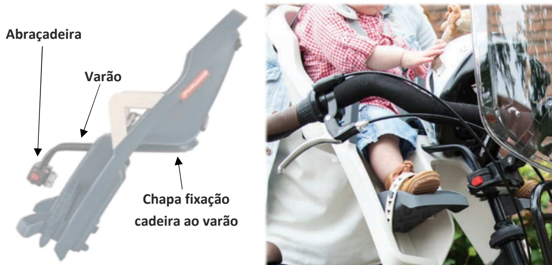
Figura 20: Exemplo de PBB com fixação à coluna de direção.
