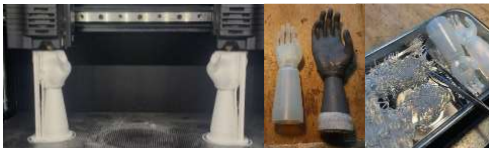
Figura 18 - Testes das mãos em PLA (esquerda); comparação de tamanhos (meio); remoção do material de suporte em resina (direita)
