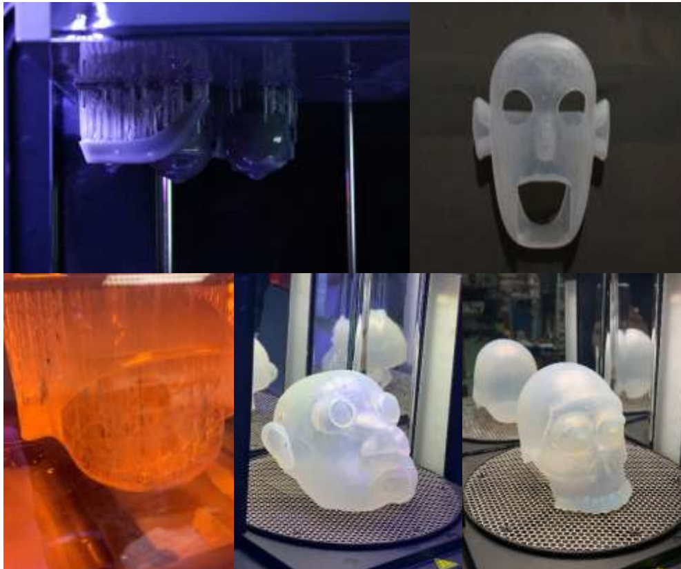
Figura 17 - Impressão em resina e cura do material
