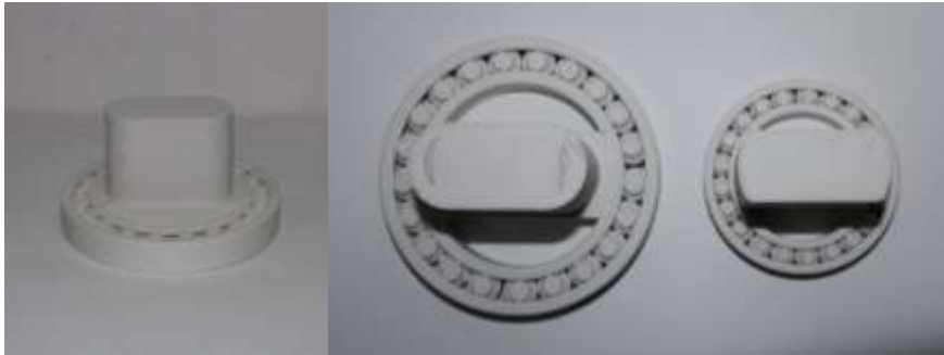
Figura 27 - Impressão do pescoço em PLA e comparação de tamanhos
