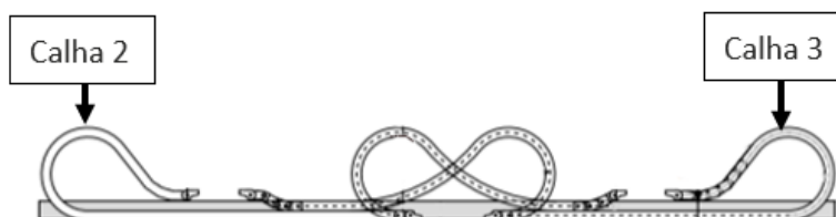
Figura 101 - Esquema do funcionamento da calha articulada da guia B (adaptado de [83])
