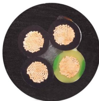
Figura 98 - Cabo utilizado pelo motor (Tipo de cabo: 4G4) [83]
