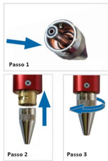
Figura 124 - Método de montagem do bico de corte sem ferramentas [95]
