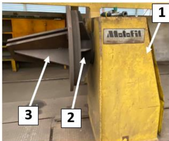
Figura 38 - Estrutura de suporte de tubos existente em chão de fábrica
