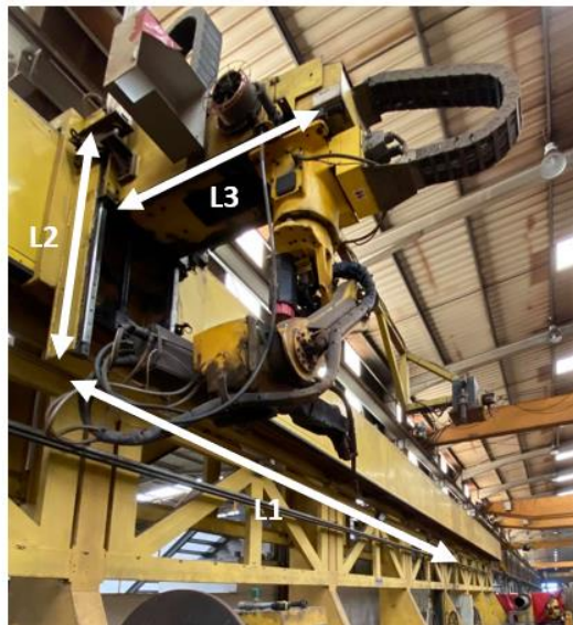
Figura 128 - Representação dos eixos de movimento auxiliares do robot FANUC M16i no pórtico existente em chão de fábrica
