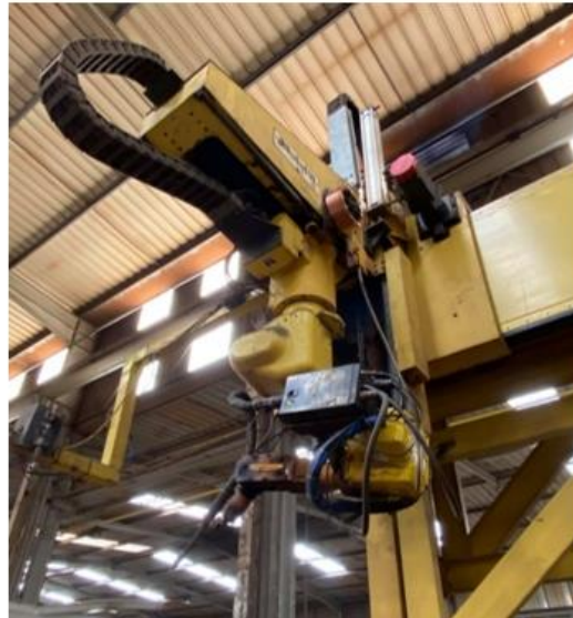
Figura 39 - Braço robótico equipado com uma cabeça de soldadura MIG/MAG
