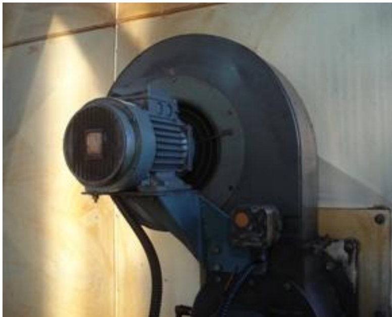
Figura 3.5 – Queimador da máquina Zell
