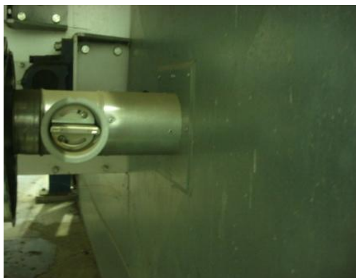
Figura 3.2 – Tubo por onde entra ar ambiente de forma natural na máquina Single End
