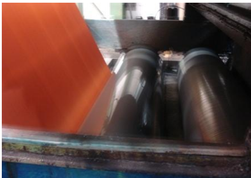
Figura 3.7 – Tina com solução de impregnação
