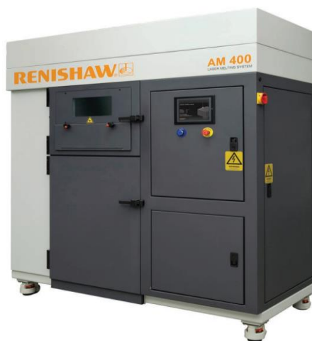
Figura 18 - Máquina utilizada no fabrico dos provetes Renishaw®, modelo AM400
