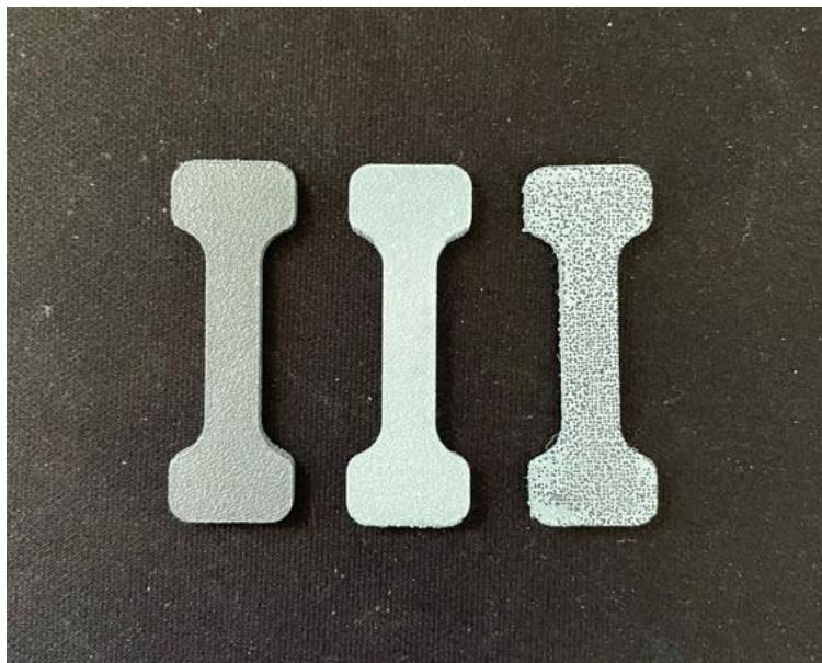
Figura 21 - Várias etapas do processo de gravação do padrão de speckle na superfície dos provetes
