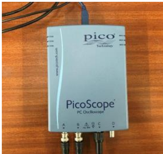
Figura 24 - Osciloscópio de quatro canais da Pico Technology®, modelo 4424
