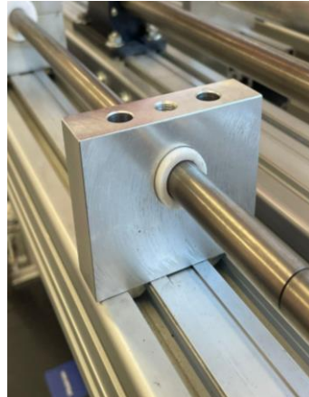
Figura 22 - Apoios das barras em teflon preparado com canais para passagem de ar comprimido
