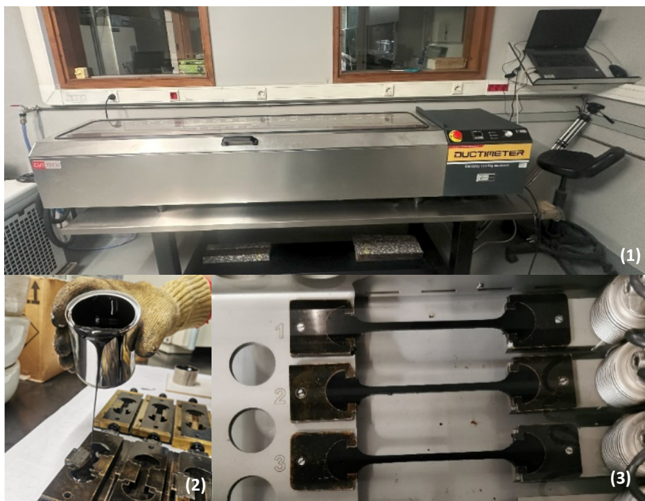
Figura 24 - Determinação da propriedade de tração de betumes modificados pelo método da força-ductilidade.
