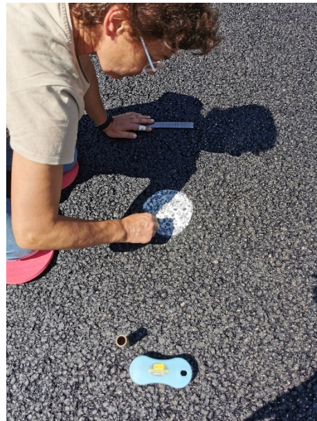
Figura 47 - Avaliação da macrotextura pelo método volumétrico.
