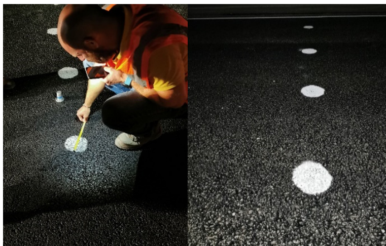
Figura 37 - Realização do ensaio para determinação da profundidade média da macrotextura em obra.
