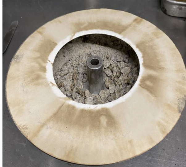
Figura 29 - Amostra após extração do betume solúvel em tetracloroetileno por centrifugação.
