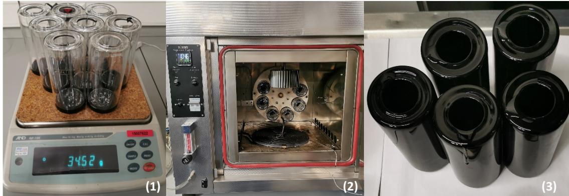
Figura 27 - Determinação da resistência ao envelhecimento sob a influência de temperatura e de um fluxo constante de ar, pelo método RTFOT.
