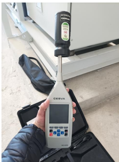
Figura 45 - Calibração do sonómetro
