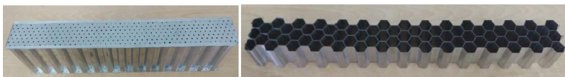
Figura 24 - (a) Amostra da primeira camada de chapa perfurada e núcleo ninho de abelha (b) Amostra da segunda camada de ninho de abelha [77]
