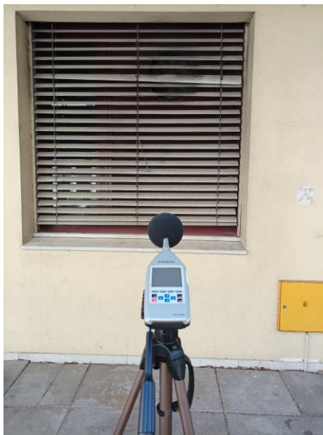
Figura 30 - Medição de ruído de ventilador axial
