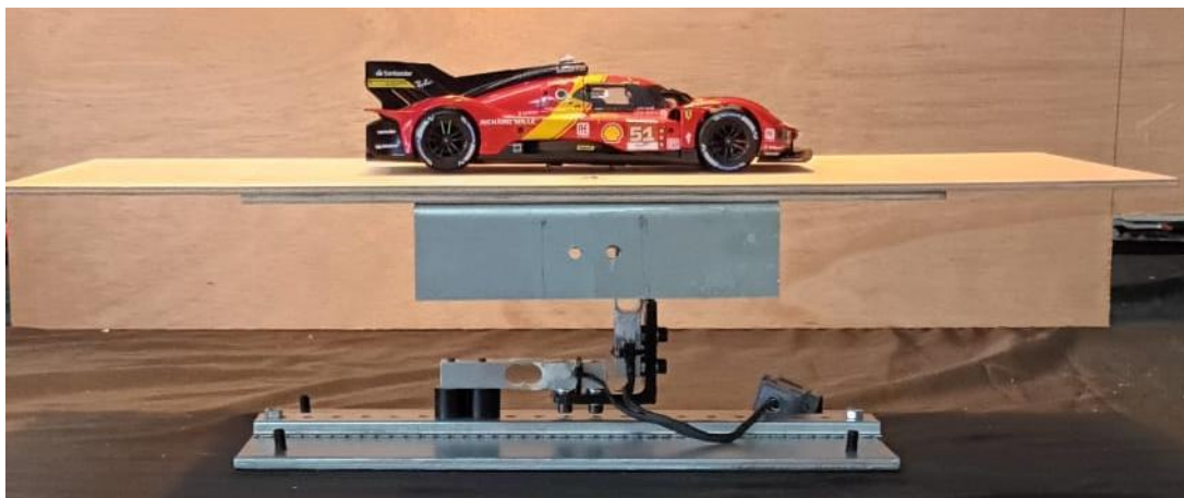
Figura 29 – Ensaio a um modelo de automóvel considerando o efeito solo.
