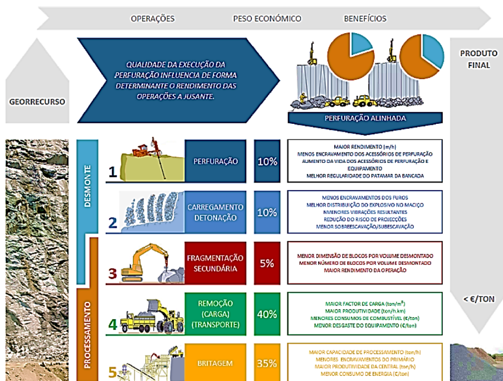
Figura 2 - Conjunto de operações consubstanciadas no processo de produção de agregados, que vão desde o maciço rochoso (georrecurso) até à obtenção de um produto rochoso final (agregado britado). Adaptado de Galiza et al. (2011)
