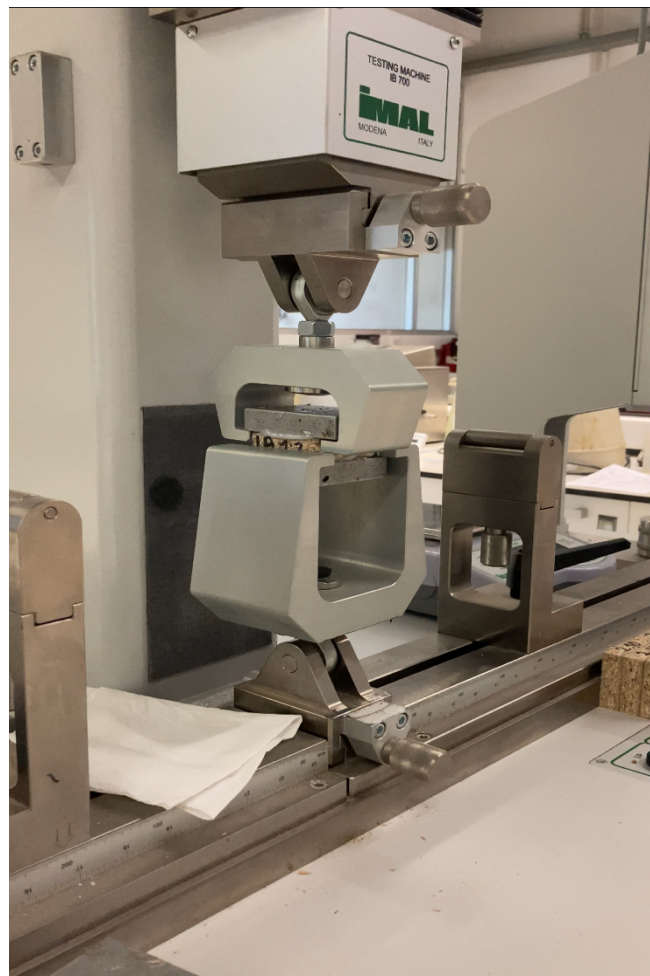
Figura 3.5 Ensaio de resistência à tração (IB).
