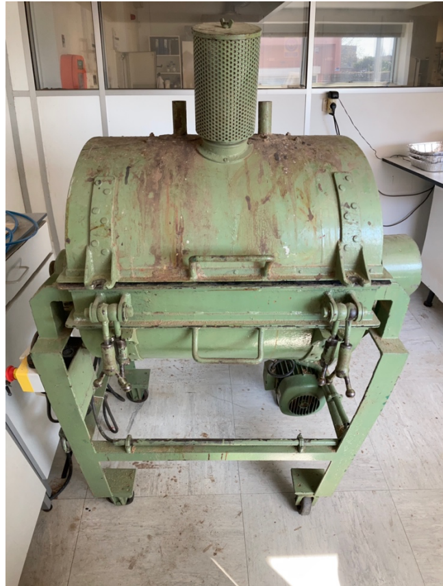
Figura 3.3 Encoladora piloto utilizada no processo de fabrico dos painéis.
