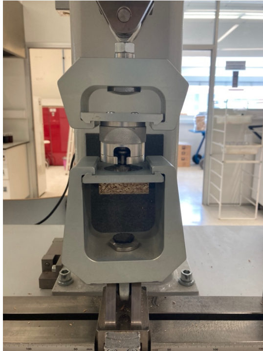
Figura 3.6 Ensaio de arranque da camada superficial.
