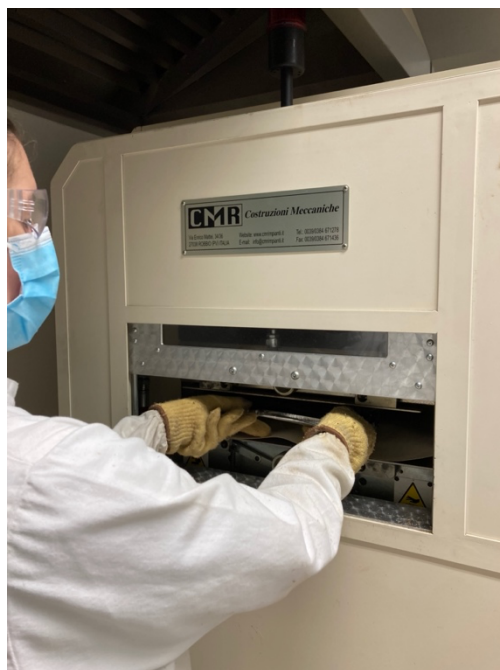
Figura 3.4 Prensagem dos painéis de aglomerado de madeira.
