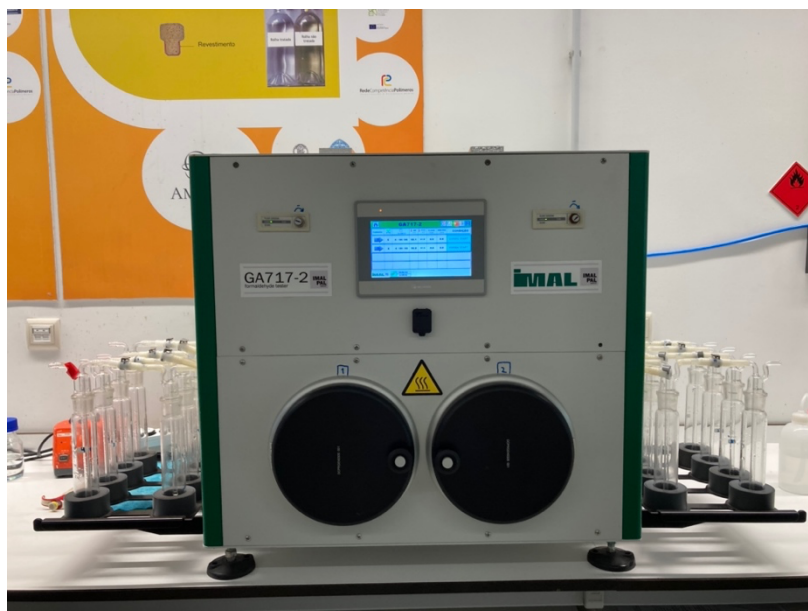
Figura 3.8 Câmara utilizada no método de análise de gás.
