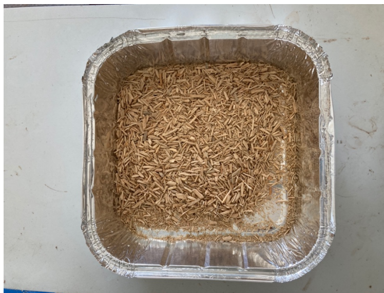
Figura 3.2 Aspeto das partículas de uma camada interna encoladas com resina.
