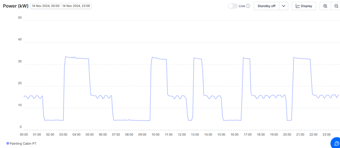
Figura 56 - Perfil de consumo elétrico semanal na Cabine de Pintura PT
