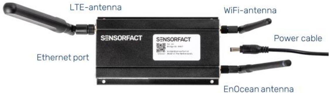
Figura 14 - Router de comunicação utilizado no projeto
