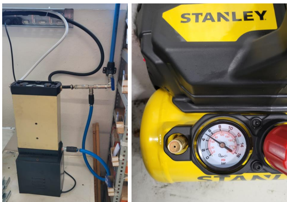
Figura 29 - Unidade autónoma de ar comprimido para as impressoras, composta por compressor e secador integrado
