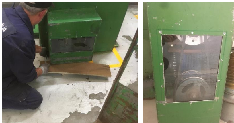
Figura 22 - inspeção com policarbonato
