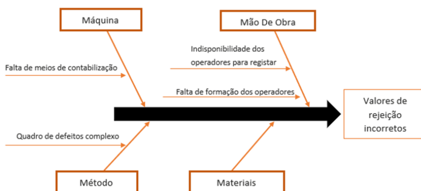
Figura 23 - Diagrama de 4M para valores de rejeição
