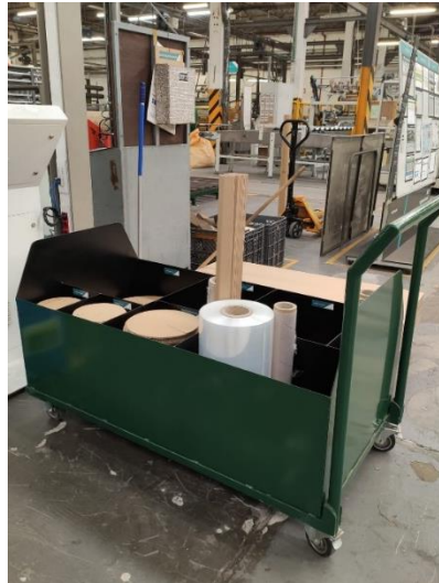
Figura 36- Armazém intermédio de matéria prima
