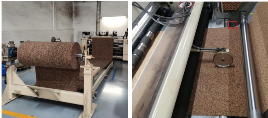
Figura 25 - Sensor na posição horizontal da mesa (estado Inicial)
