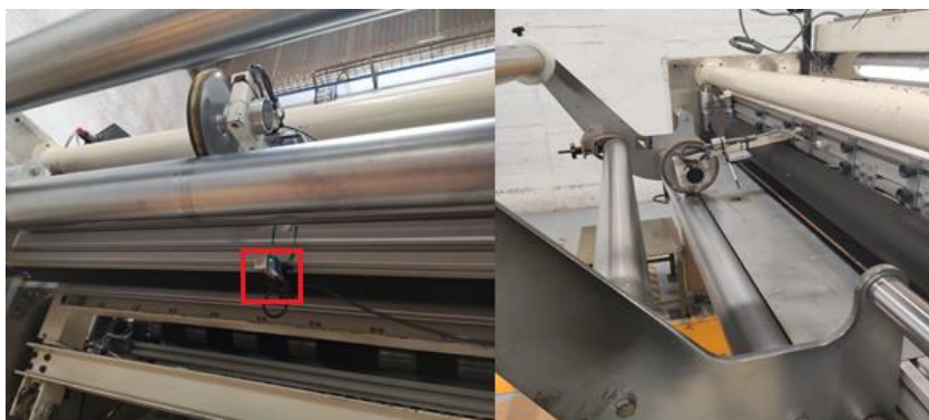
Figura 26 - Sensor na posição vertical da mesa (estado Fina)
