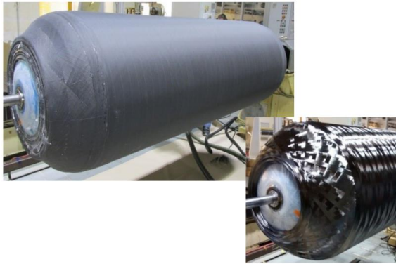
Figura 2.1-12 - Involucro de foguete sólido produzido por infusão assistido por AFP de fibra seca[48].
