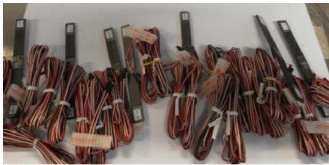
Figura 3.1-6 - Provetes de compressão instrumentados.
