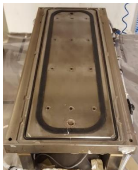
Figura 3.2-1 - Molde inferior com vedantes e pinch-off .
