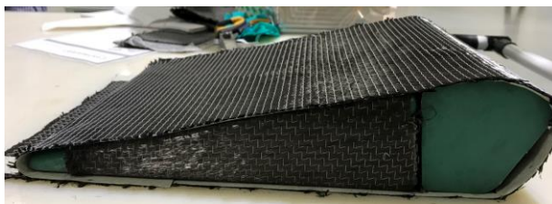
Figura 3.1-30 - Teste de laminação com divisão das camadas laterais e alívio dos vértices – molde do caixão central e bordo de ataque todos laminados com a 1ª camada
