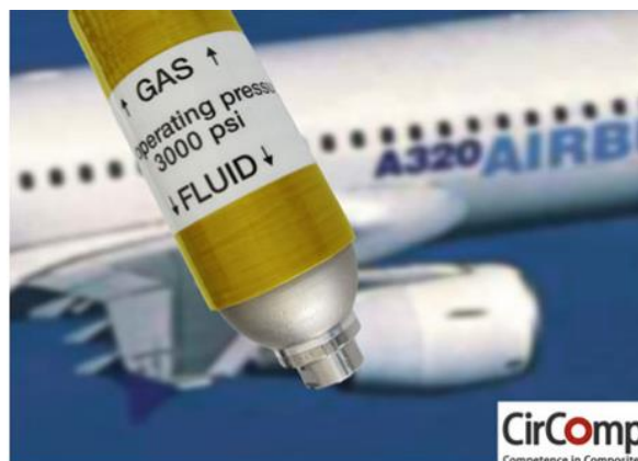
Figura 2.1-26 - Reservatório de pressão do sistema hidráulico type II do Airbus A320 [45].
