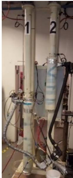
Figura 3.2-10 - Equipamento de injeção para RTM .
