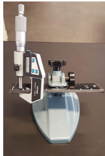
Figura 3.2-15 - Setup e equipamento utilizado na medição de espessuras.
