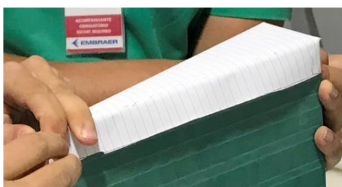
Figura 3.1-31 - Teste de laminação com divisão das camadas laterais e vértices em ângulo
