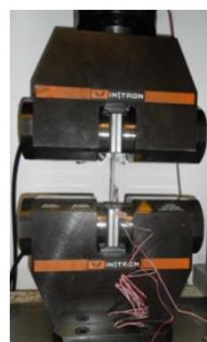
Figura 3.1-5 - Amarras hidráulicas utilizadas no ensaio de tração
