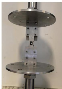
Figura 3.1-8 - Ferramenta de ensaio OHC.
