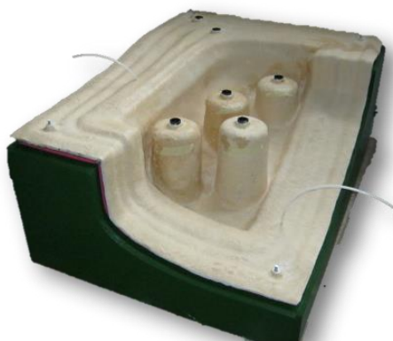
Figura 2.1-29 - Molde de Light RTM [61].
