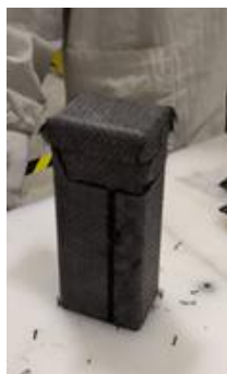
Figura 3.1-22 - 1ª e 2ª camadas já laminadas no molde interno
