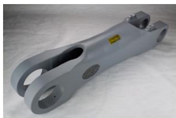
Figura 2.1-34 – Componente do Trem de pouso principal do Boeing 787 [68].
