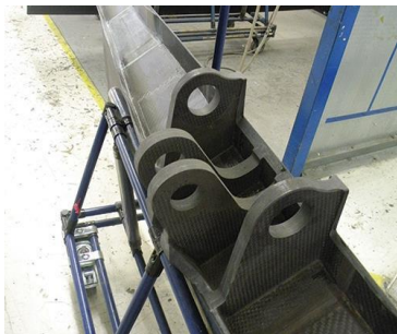
Figura 2.1-32 – Ligação do aileron do A350 [66].
