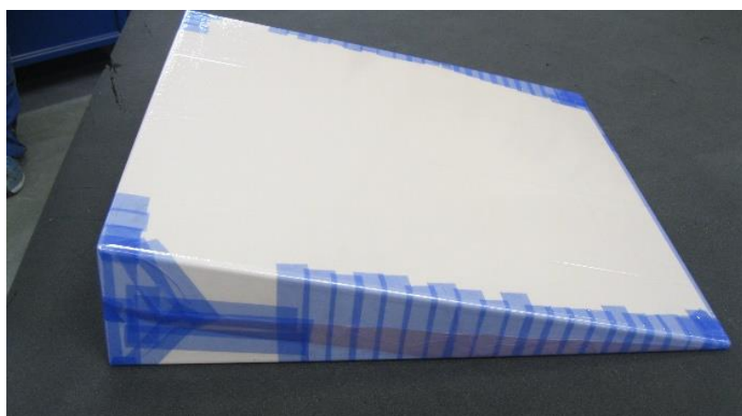
Figura 3.5-18 - Molde em areia solúvel do demonstrador de processo.
