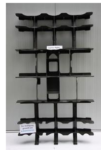
Figura 2.1-33 – Estrutura interna da porta do A350 [67].
