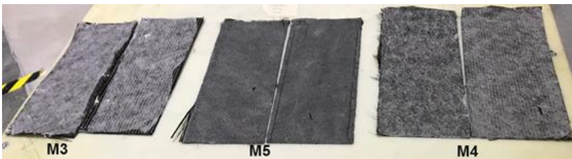
Figura 3.1-12 - Camadas de reforço de fibra dos diferentes fornecedores após corte em máquina de corte automático.
