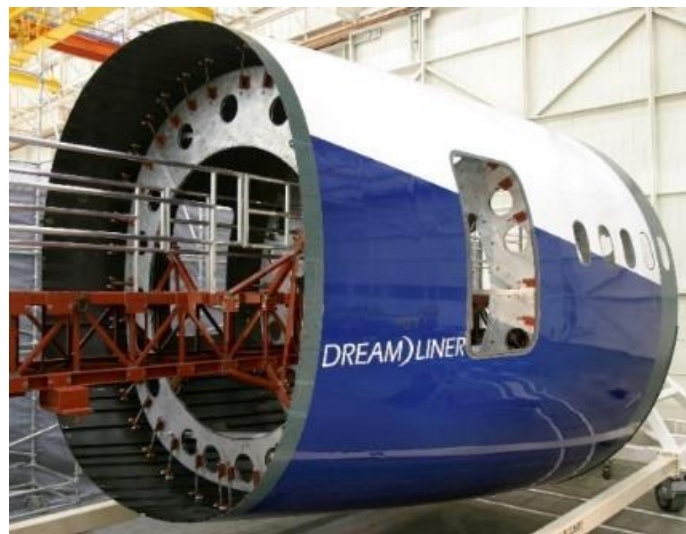
Figura 2.1-3 - Secção de Fuselagem do Boeing 787 Dreamliner em compósito Carbono/Epóxido. [16]
