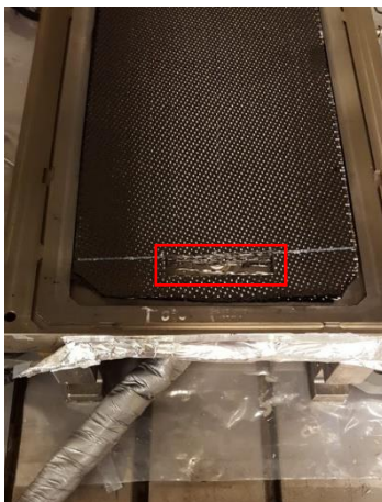
Figura 3.2-11 - Reforços colocados no setup de RTM e respetivo corte na zona de injeção, representado a vermelho.
