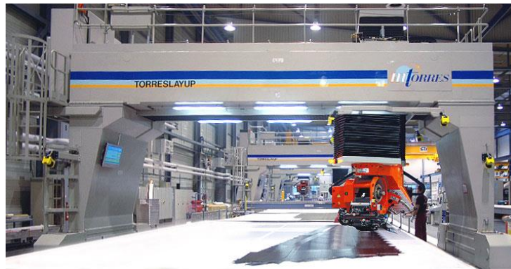
Figura 2.1-14 - Equipamento ATL (Mtorres) [52].
