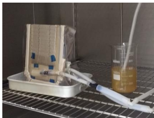
Figura 3.1-15 - Infusão em estufa da subestrutura A
