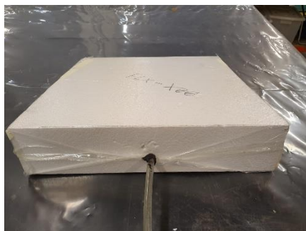
Figura 3.5-20 - Molde interno para técnica blow molding em EPS revestido a membrana.
