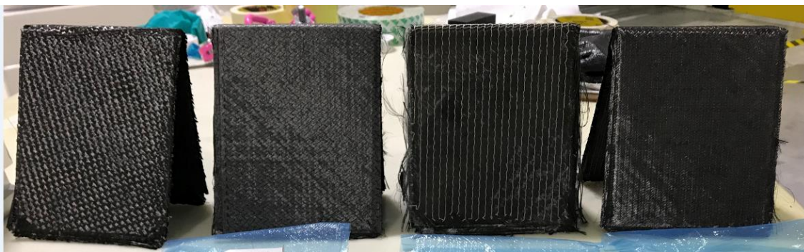
Figura 3.1-13 - Pré-formas da subestrutura A, dos diferentes materiais.
