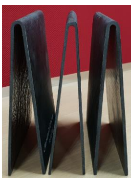
Figura 3.1-32 - Vista lateral das subestruturas A fabricadas – Da esquerda para direita materiais M3, M4 e M5, respetivamente.
