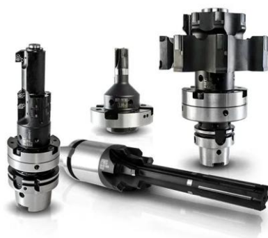
Figura 9 – Ferramentas com arestas de corte em PCD [21].
