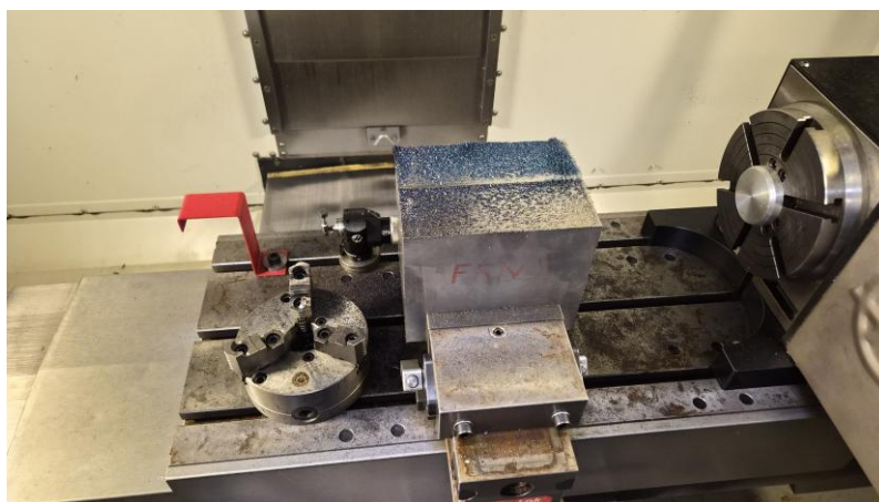
Figura 20 – Bloco maquinado após o primeiro ensaio.
