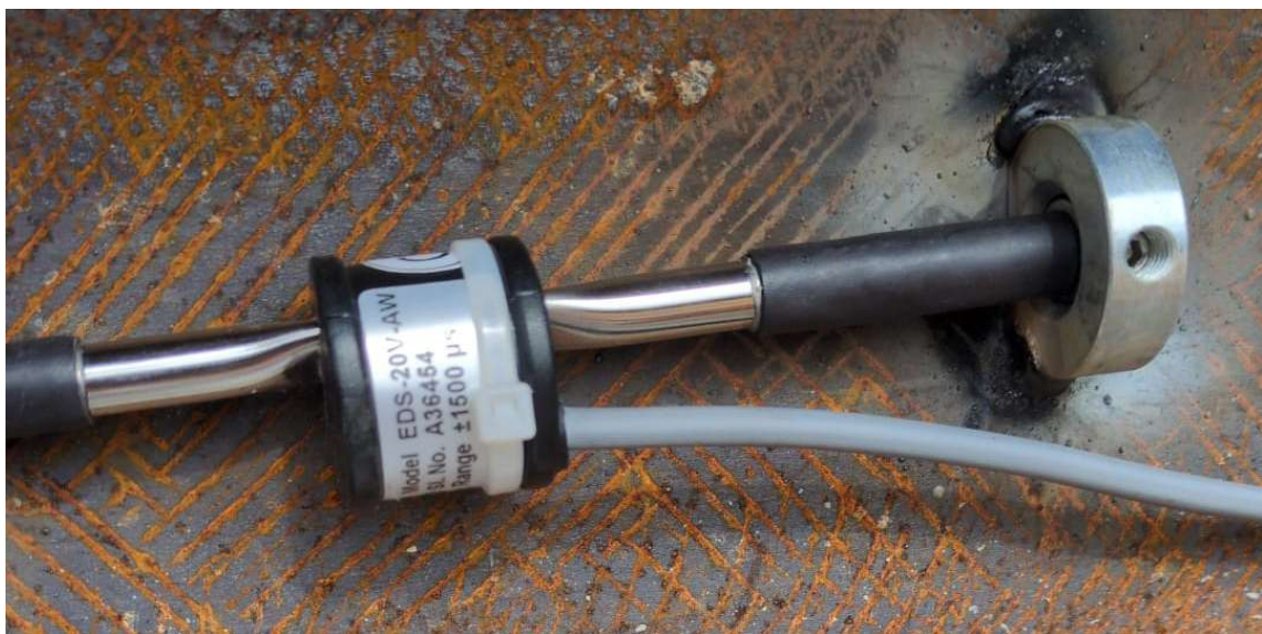
Figura 22- Exemplo de um modelo Strain Gauge .
