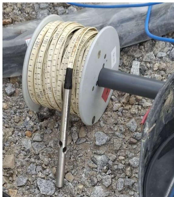
Figura 6- Sonda de nível de água- Modelo EPP- 10/6, na esquerda. Na direita, modelo usado em campo.
