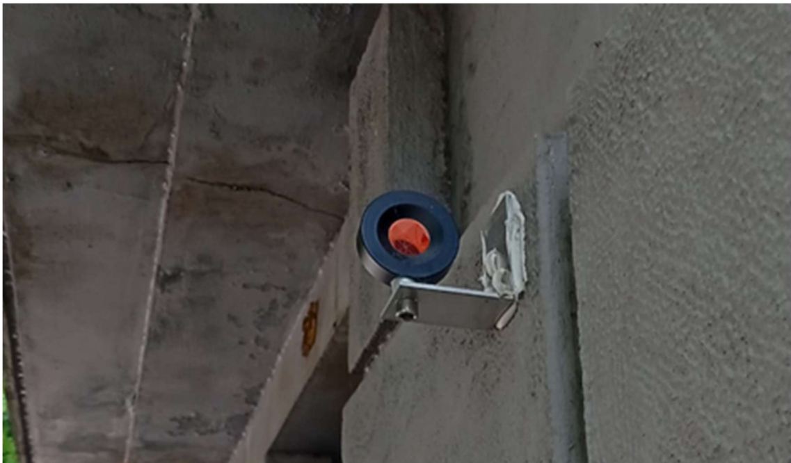
Figura 14- Prisma topográfico com L-bar .
