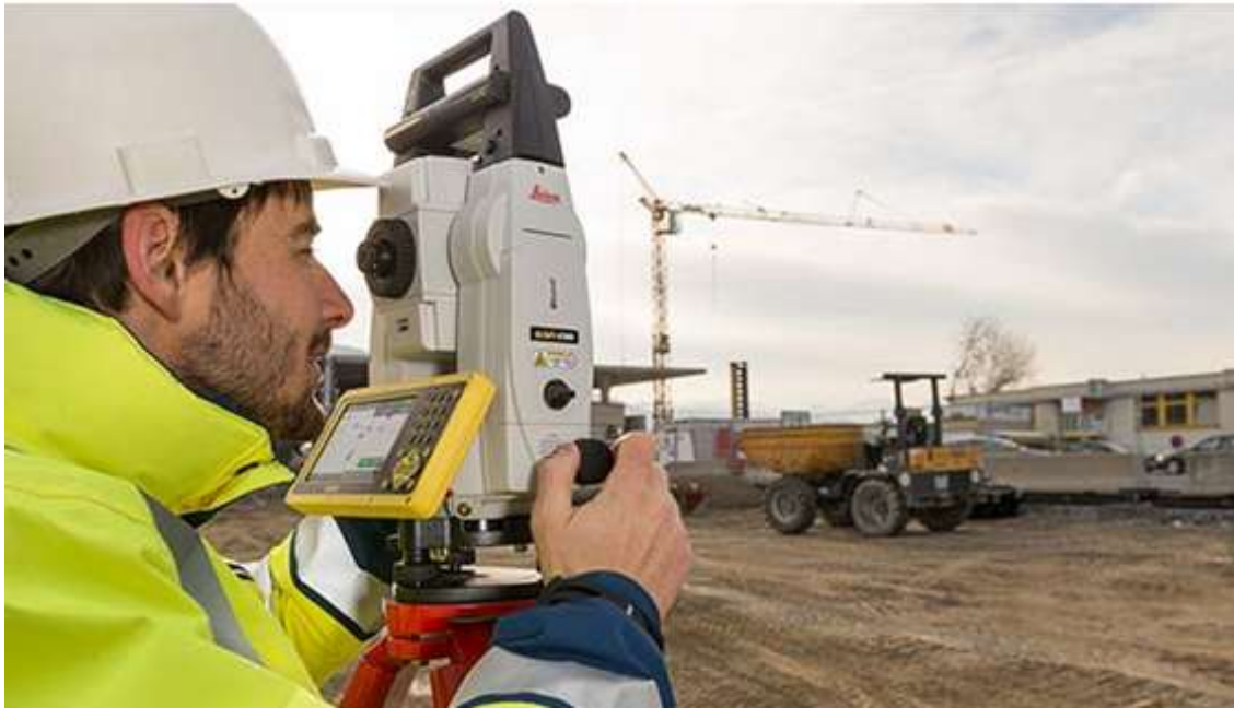
Figura 10- Estação Total manual, manobrada por um técnico especializado (Hexagon, s.d.).
