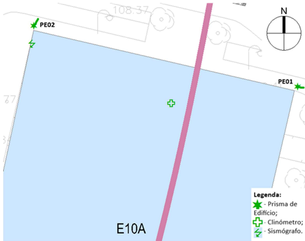
Figura 57- Edifícios E10A, respectivos Prismas de Edifícios, Clinómetro e Sismógrafo (excerto de relatório de projeto; gentilmente cedido pela ACA).
