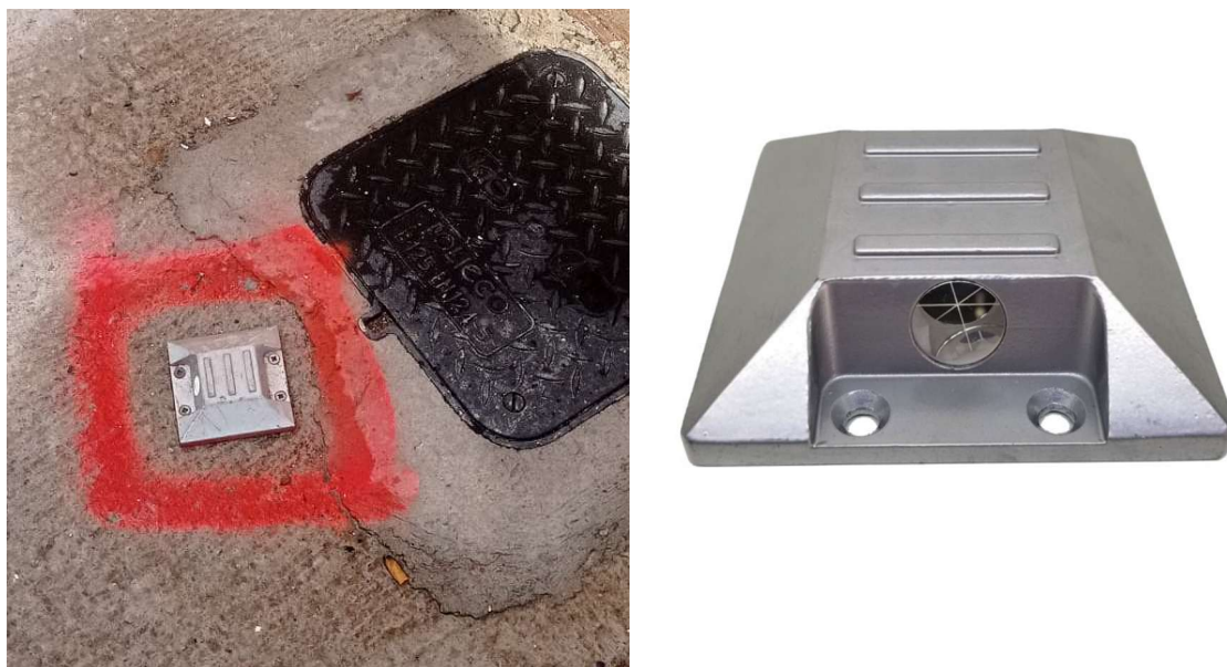
Figura 15- À direita, prisma de pavimento ao lado de uma tampa de extensómetro. Na esquerda, prisma de 17,8mm.
