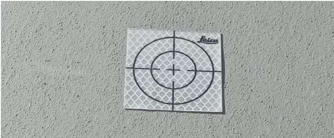
Figura 12- Alvo topográfico numa estrutura.
