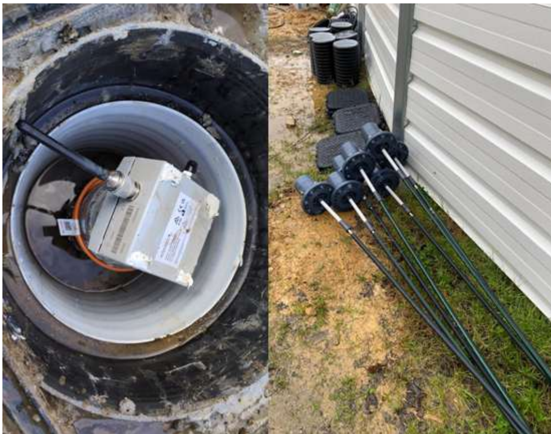
Figura 21- Sensor de corda vibrante (direita). Extensómetro, caixas e cabeçal PVC (esquerda).
