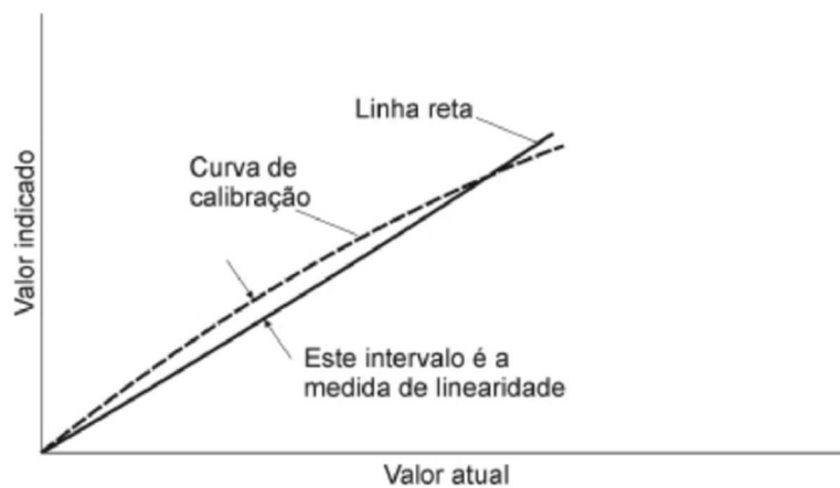
Figura 3- Representação gráfica da linearidade de um dispositivo de instrumentação. (Silveira, 2013)
