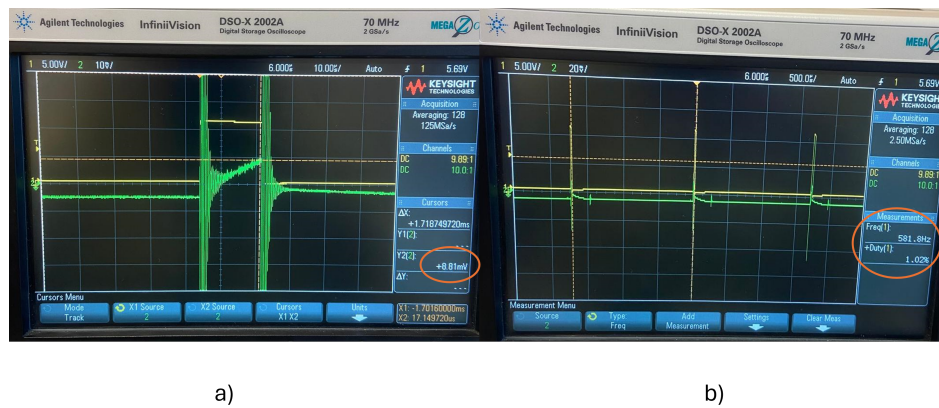
Figura 4.11: Corrente no indutor para o valor mínimo de duty cycle a) 1 período e b) 3 períodos.
