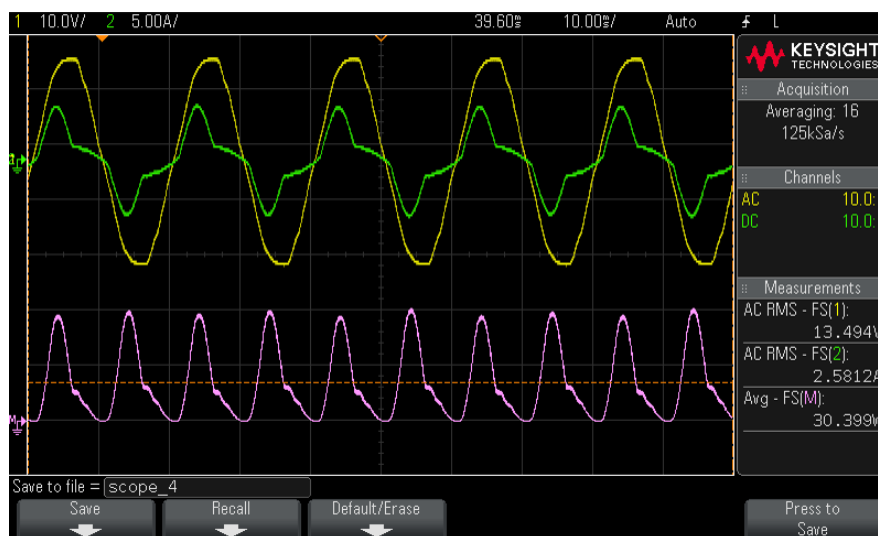
Figura A.6: Carga 100\Omega ; Corrente de entrada (canal 2); Tensão de entrada (canal 1); Potência instantânea (roxo).
