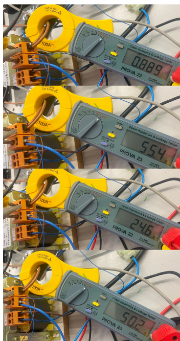
Figura A.8: Carga 50\ \Omega a) Fator de potência, b) Potência aparente, c) Potência reativa, d) Potência ativa.
