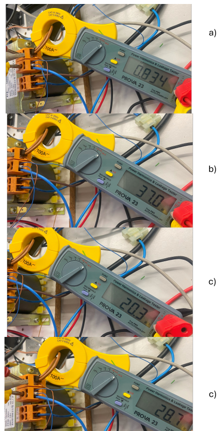
Figura A.5: Carga 100\Omega ; a) Fator de potência, b) Potência aparente, c) Potência reativa, d) Potência ativa.
