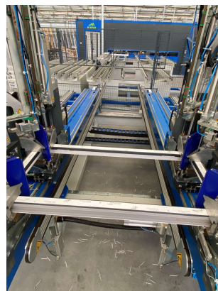
Figura 31 - Fase de aquecimento das extremidades
