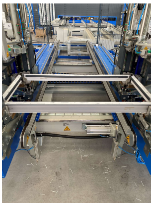
Figura 30 - Fase de inserção dos perfis
