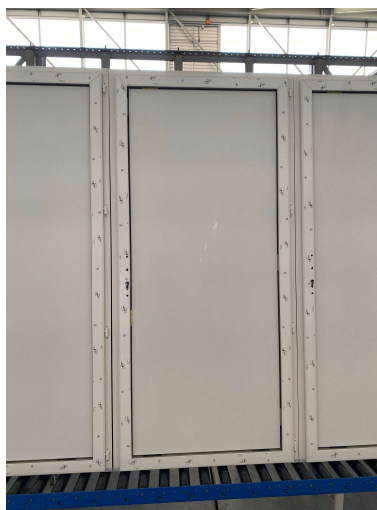
Figura 40 - Montagem do painel na porta
