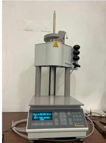
Figura 17 Equipamento de medição do índice de fluidez
