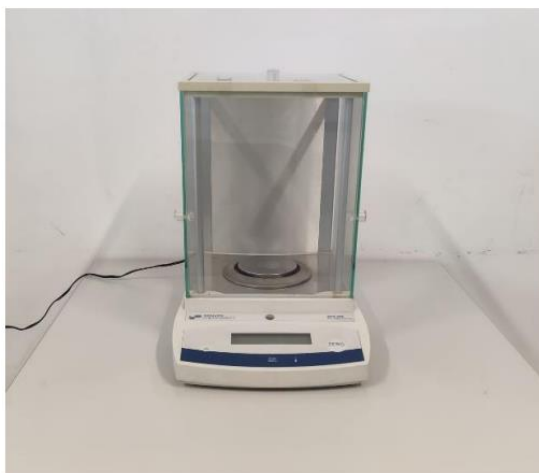
Figura 29 Balança de precisão
