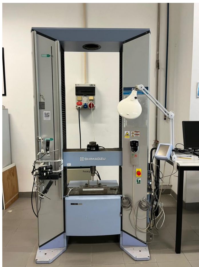
Figura 33 Máquina universal de ensaios SHIMADZU AG-X 100 kN
