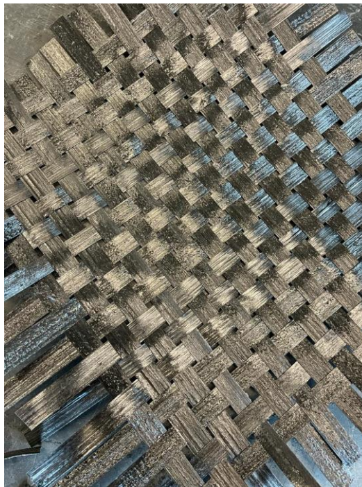
Figura 26 Camada de tecido de fitas pré-impregnadas
