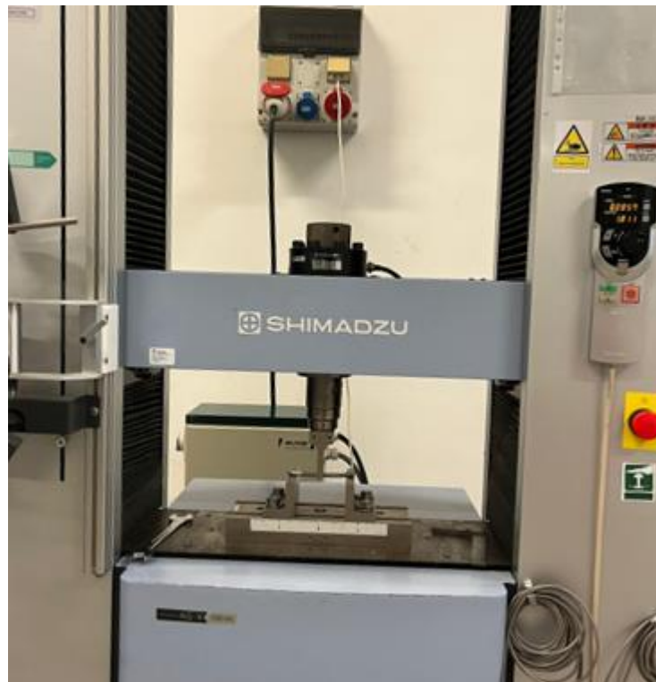
Figura 34 Provete a ser ensaiado à flexão
