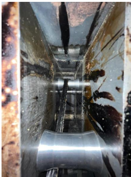
Figura 22 Sistema de rolos de impregnação
