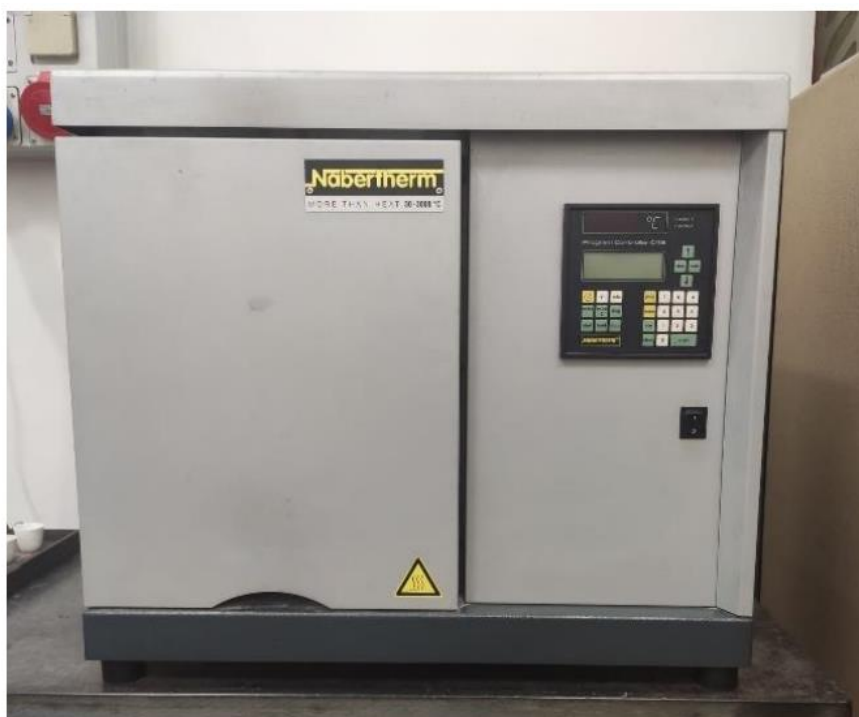
Figura 28 Forno mufla NABERTHERM LHT08/16.
