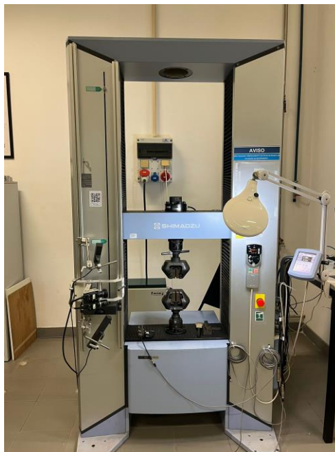
Figura 32 Equipamento de ensaios SHIMADZU AG-X 100 kN
