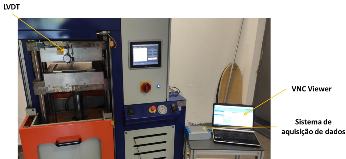
Figura 27 Setup dos equipamentos de controlo de LVDT
