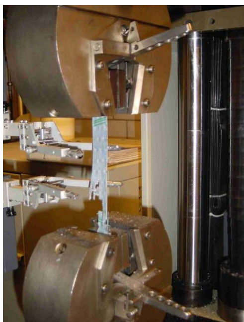
Figura 66 - Provete na máquina de tração após a rotura
