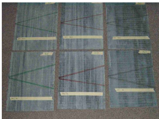
Figura 57 - Tecido impregnado com o comprimento pretendido para ensaio
