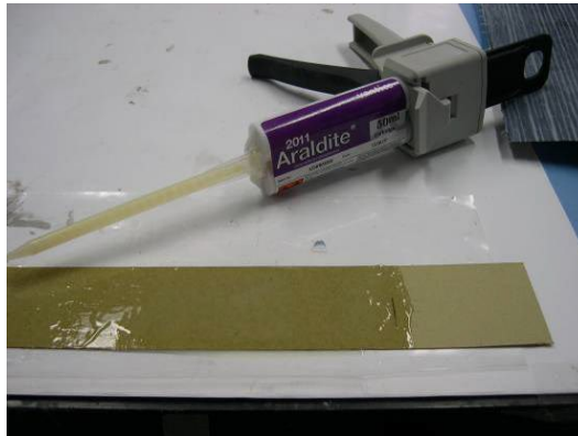
Figura 58 - Aplicação de cola na aba para extremidades
