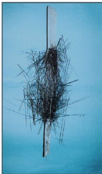
Figura 51 - Pormenor de rotura do laminado por tração
