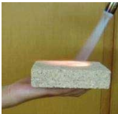
Figura 40 - Placa de vermiculite exposta ao fogo
