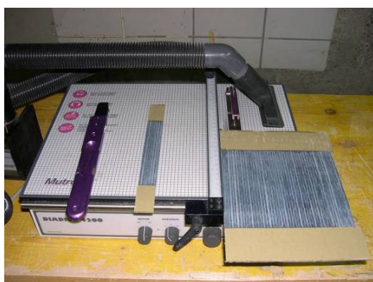
Figura 62 - Corte do corpo de prova com a largura pretendida para ensaio
