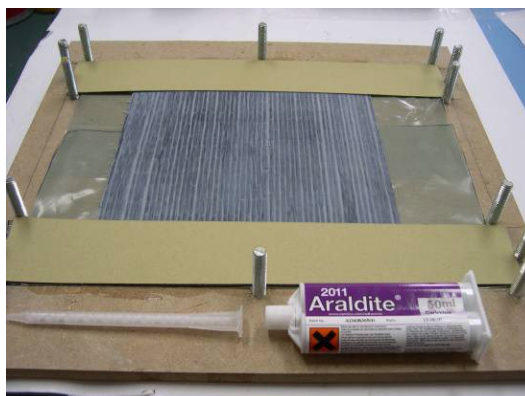
Figura 60 - Colagem da aba superior no laminado
