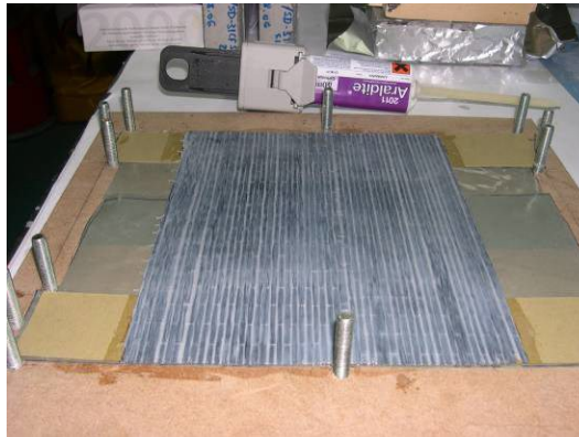
Figura 59 - Colagem da aba inferior no laminado
