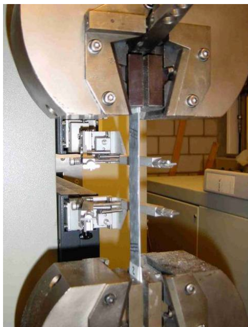
Figura 65 - Provete na máquina de tração antes da rotura
