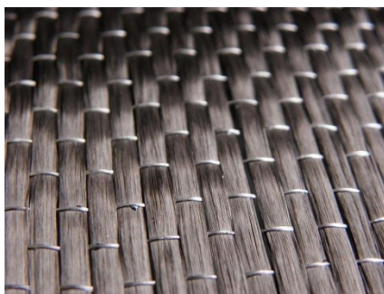
Figura 17 - Tecido de fibra de carbono unidirecional
