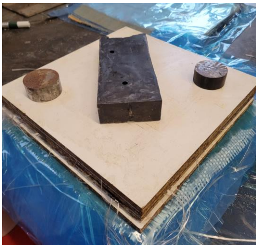
Figura 15 - Processo de cura dos laminados
