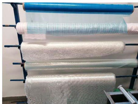
Figura 12 - Fibra de vidro sob a forma de manta e tecido
