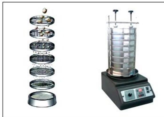
Figura 7: Análise Granulométrica: conjunto de peneiros e peneirador mecânico (retirado de https://dynapac.blog/ , em 27/03/2024).
