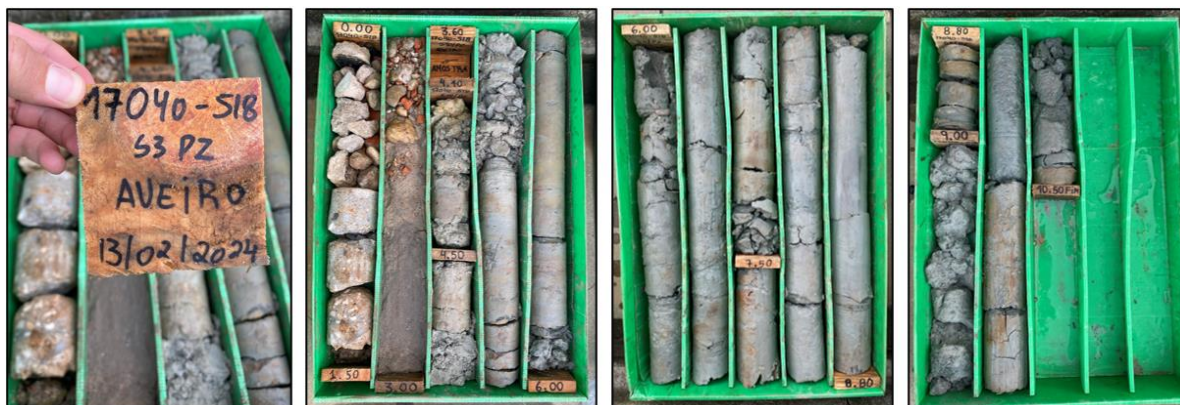
Figura 25: Exemplo das caixas referentes às amostras de uma sondagem (S3-Pz).
