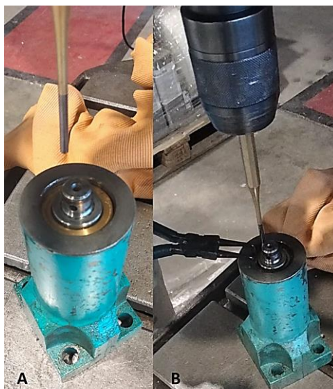
Figura 64- A- Posicionamento do calcador em função do ponteiro. B- Pressão aplicada na mola para a colocação do freio.
