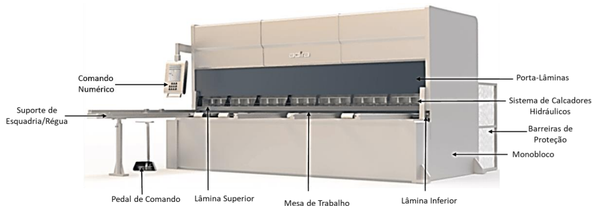
Figura 10- Componentes da guilhotina GV através de uma vista frontal (elaboração própria).
