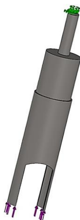
Figura 87- Ilustração da aplicação da força no ponteiro central da ferramenta.
