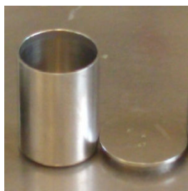
Figura 2.9 - Picnómetro para determinação da densidade de uma tinta.
