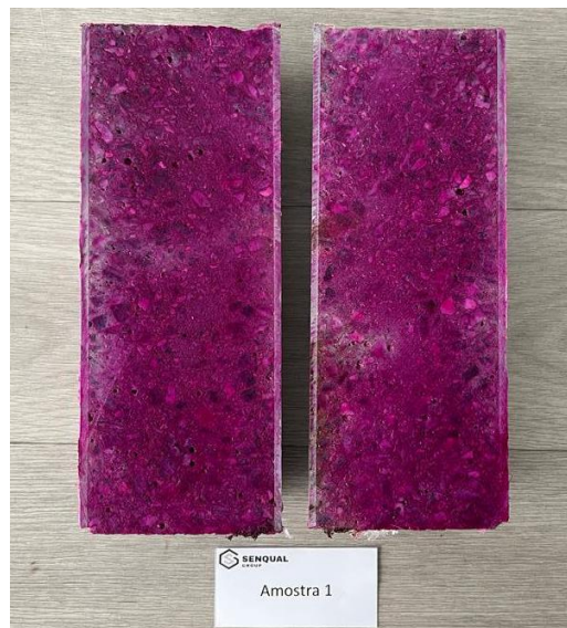
Figura 6.2 - Ensaio de carbonatação na amostra 1
