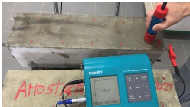
Figura 4.2 - Equipamento e execução do ensaio de potencial de corrosão.
