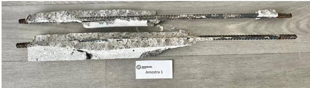
Figura 6.11 - Varões de aço retirados do prisma da amostra 1, no qual a sua cura foi realizada em água normal
