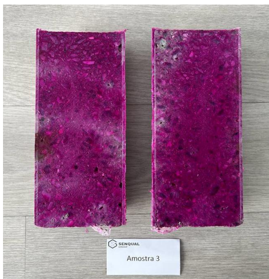
Figura 6.4 - Ensaio de carbonatação amostra 3
