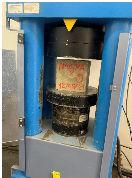
Figura 4.6 - Ensaio de resistência à compressão
