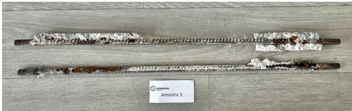
Figura 6.21 - Varões de aço retirados dos provetes da amostra 3, no qual a sua cura foi realizada em água do mar
