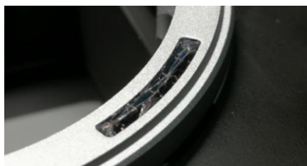
Figura 22 - Janela do aro da baioneta partida
