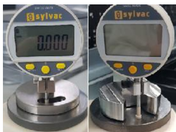
Figura 24 - Mecanismo de medição aro da baioneta e mecanismo de medição da placa BJ
