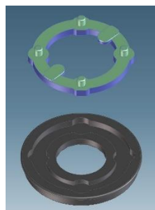
Figura 26 – Ilustração dos componentes do botão direcional de cruz
