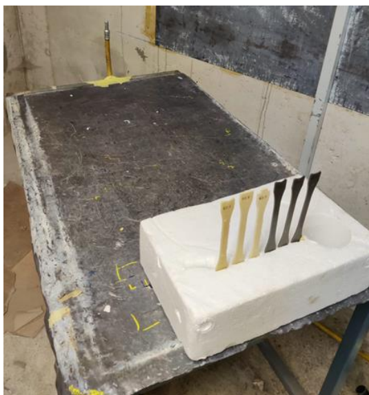
Figura 59 - Montagem da fonte de selênio para irradiação dos provetes
