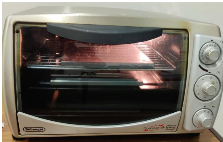
Figura 40 – Aquecimento, no forno, das placas constituintes do molde
