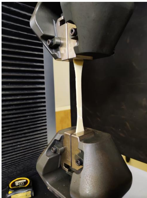
Figura 67 - Fixação de provete de adesivo Sikaforce® 7818 L7
