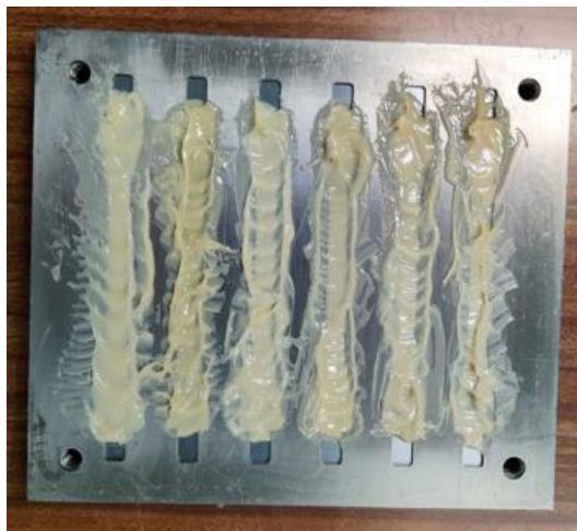
Figura 46 - Adesivo Sikaforce® 7818 L7 aplicado e compactado no molde
