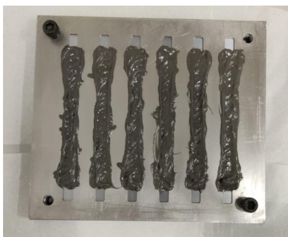
Figura 43 - Adesivo Araldite® AV138 aplicado e compactado no molde
