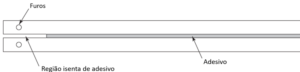
Figura 21 - Representação de um provete DCB segundo a norma ASTM D3433-99, adaptado de da Silva et al. (2012)
