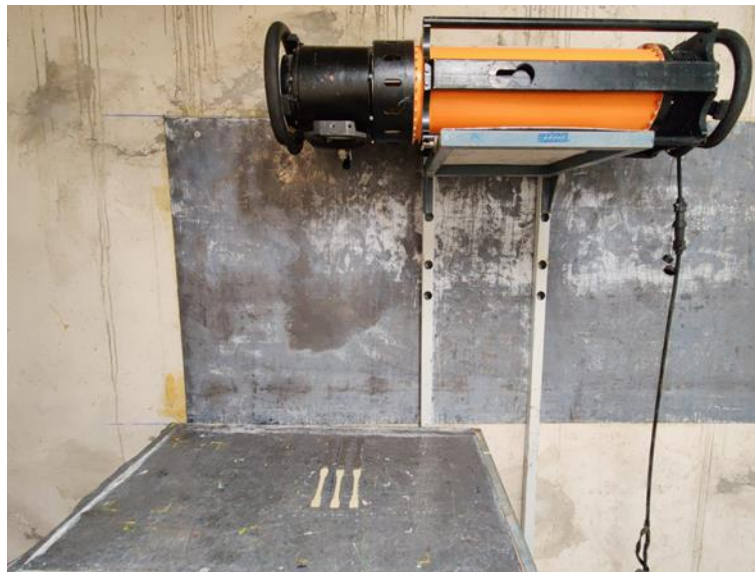
Figura 62 - Preparação dos provetes e gerador de raios X
