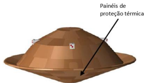
Figura 9 - Painéis de proteção térmica colados a cápsula corporal para reentrada na atmosfera, adaptado de Désagulier et al. (2018)
