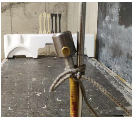
Figura 61 - Colocação de um colimador na ponteira do tubo guia
