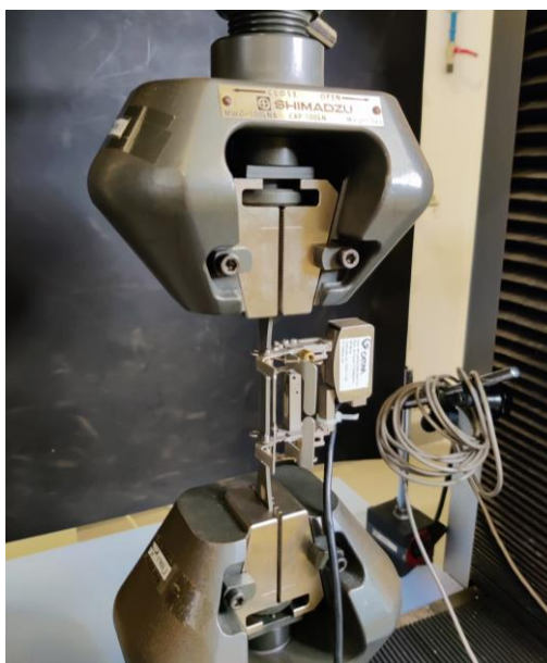
Figura 68 – Setup do ensaio de tração a um provete de adesivo Araldite® AV138
