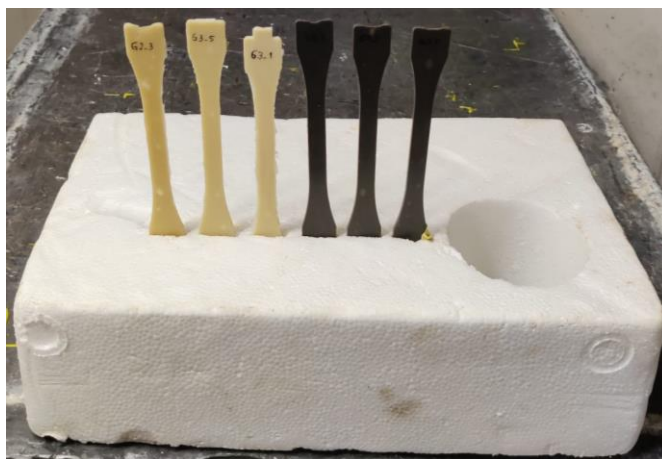
Figura 58 - Fixação dos provetes em esferovite
