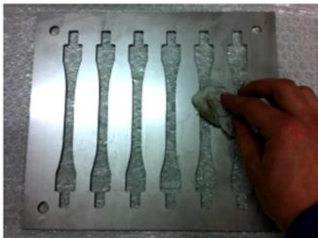
Figura 39 - Limpeza da placa intermédia do molde com acetona
