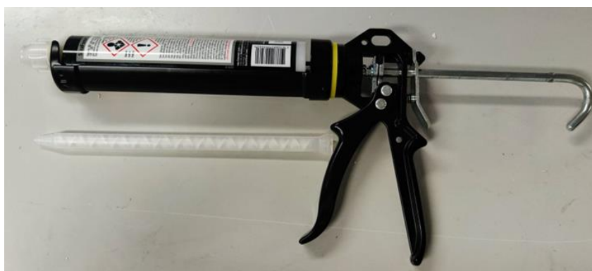
Figura 36 - Pistola Sika® com bico de mistura de núcleo helicoidal
