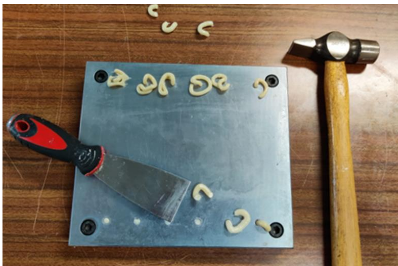
Figura 48 - Remoção do adesivo excedente sobre a placa superior
