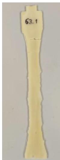
Figura 78 - Provete G3_1 de adesivo Sikaforce® 7818 L7 dado como inválido
