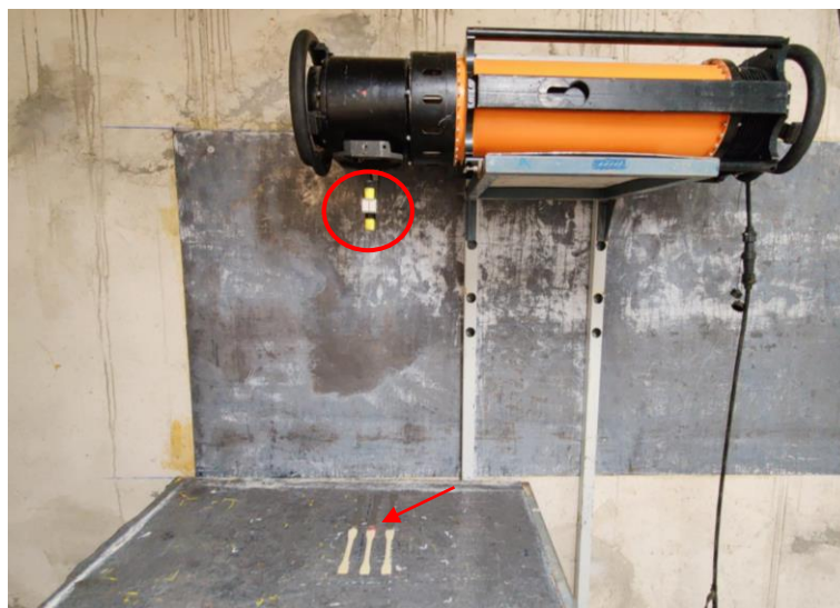
Figura 63 - Posicionamento dos provetes de acordo com o laser do gerador de raios X
