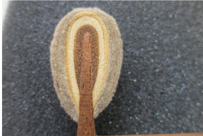
Figura 6: Revestimento de martelo com duas camadas de feltro de um piano Pleyel 10966, que pertenceu a Gioachino Rossini. Museo della Musica, Bologna.
