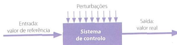
Figura 1. Diagrama de blocos de um processo de controlo em malha aberta.
