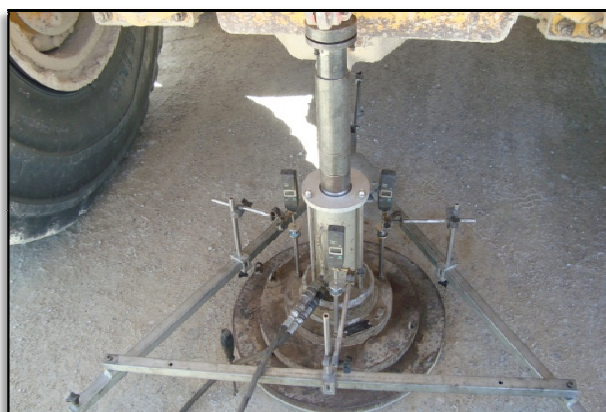
Figura 6.4 – Ensaio de carga em placa realizado na campanha de ensaios
