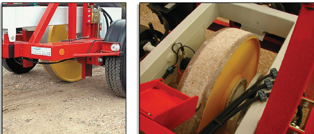
Figura 5.13 – Roda vibrante instrumentada com acelerómetros (Fonte: http://www.lcpc.fr/ )
