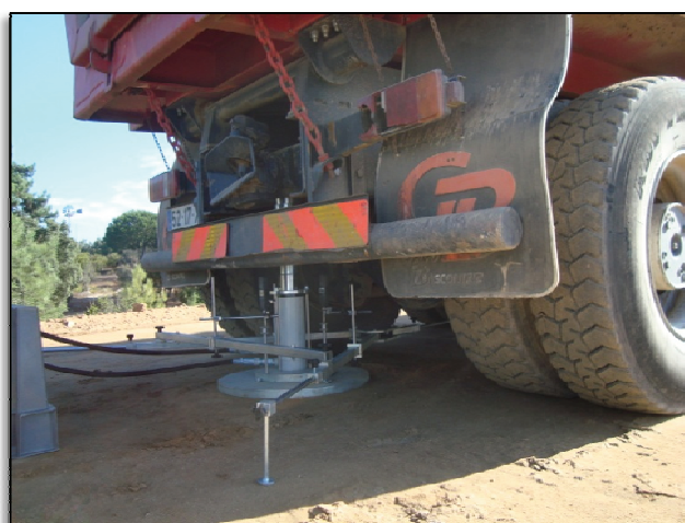
Figura 6.33 – Ensaio de carga em placa
