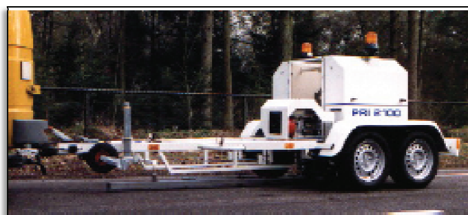
Figura 5.7 – Deflectómetro de impacto pesado (Fonte: Alves, 2007)
