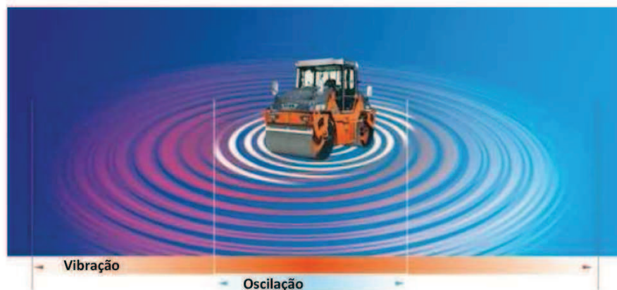
Figura 4.6 – Efeito vibrador e oscilador num cilindro (Fonte: Adaptado de www.hamm-ag.de/en/technologien/oszillation/index.html )
