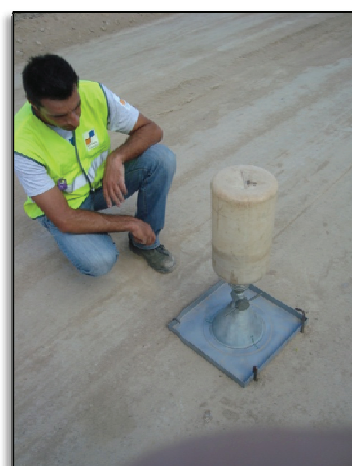
Figura 6.49 – Ensaio de garrafa de areia
