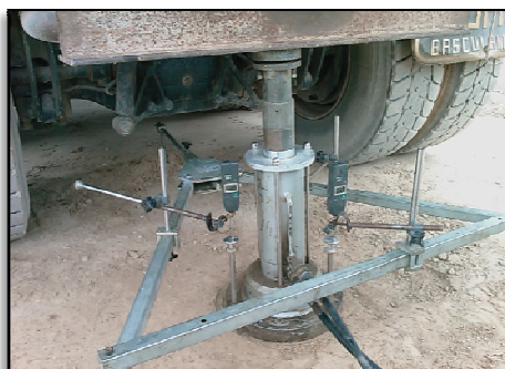
Figura 5.5 – Esquema do ensaio de carga em placa (Fonte: Vaz, 2005)
