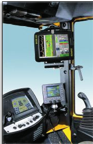
Figura 4.11 - Interior de um equipamento apetrechado com sistema de controlo de compactação inteligente (Fonte: http://www.bomag.com/worldwide/index.aspx?&Lang=10000 )
