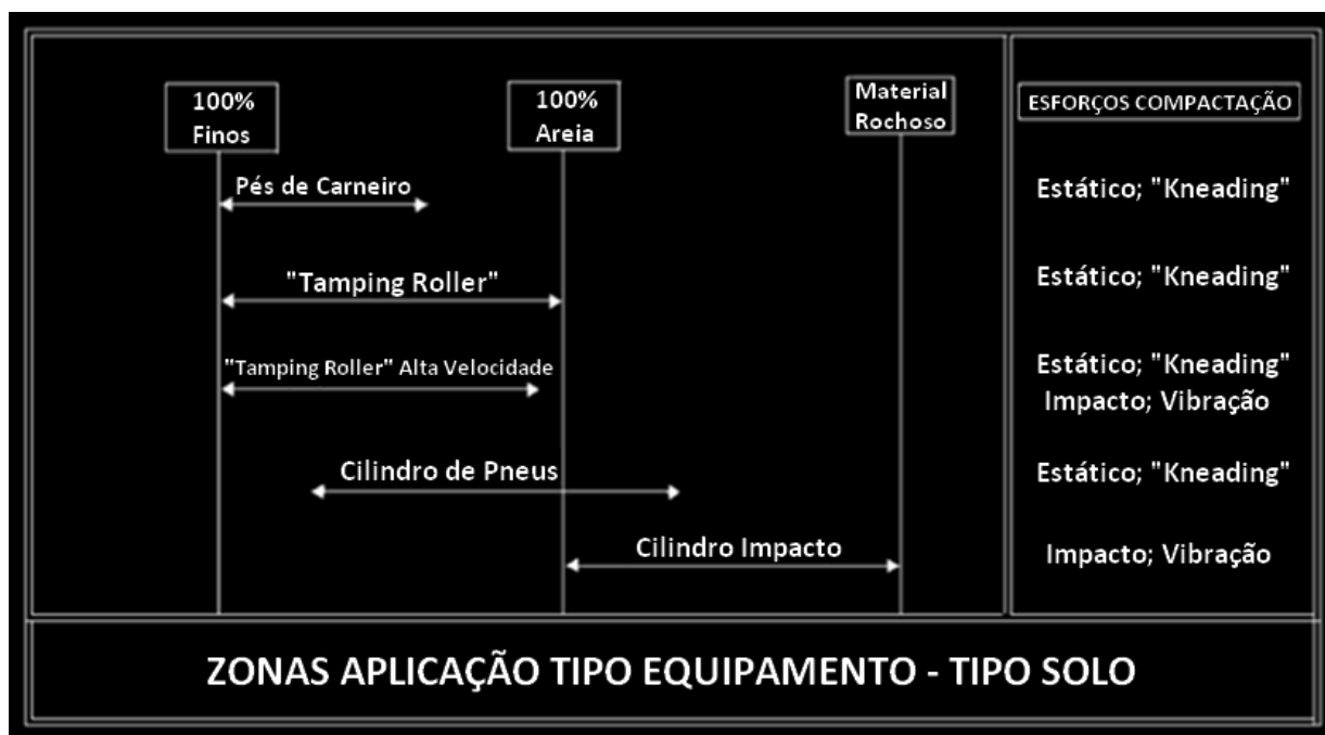
Figura 4.12 – Esquema representativo da aplicação dos diferentes tipos de equipamentos em função do material a compactar (Fonte: Adaptado de Holtz & Kovacs, 1981)
