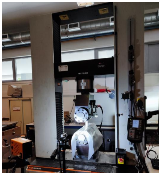
Figura 24 - Setup usado para o ensaio de tração dos provetes cross-ply .
