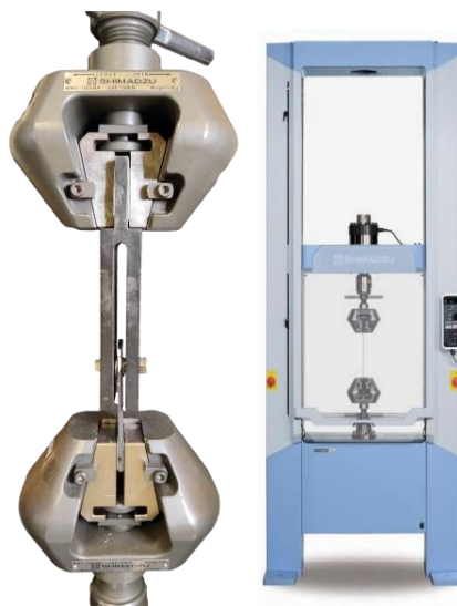
Figura 33 - Suporte usado no ensaio Bearing (esquerda) (8). Máquina universal de ensaios AG-X Plus (Shimadzu, Japão) (direita) (69).
