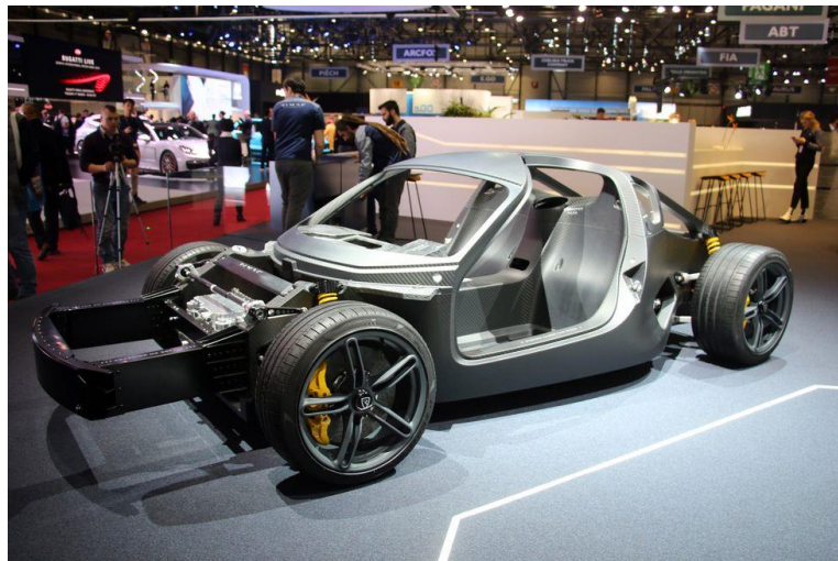
Figura 5 - Monocoque do carro C_two da Rimac (23).
