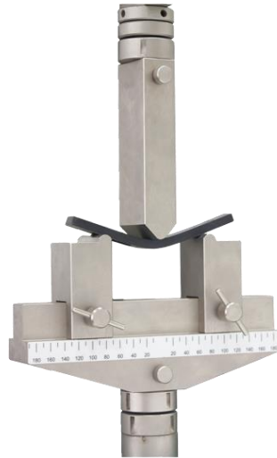
Figura 23 - Exemplo de um ensaio de flexão de 3 pontos (60).
