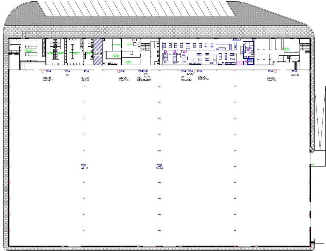
Figura 24 - Levantamento de quadros elétricos existentes na UAP4
