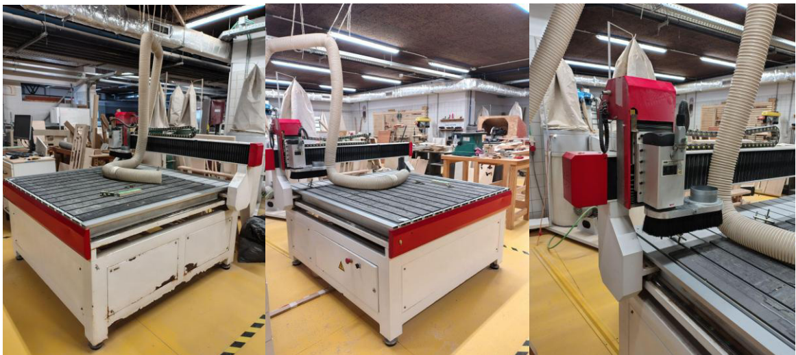
Figura 74 Laboratório da ESMAD - Máquina CNC utilizada para o corte das peças.
