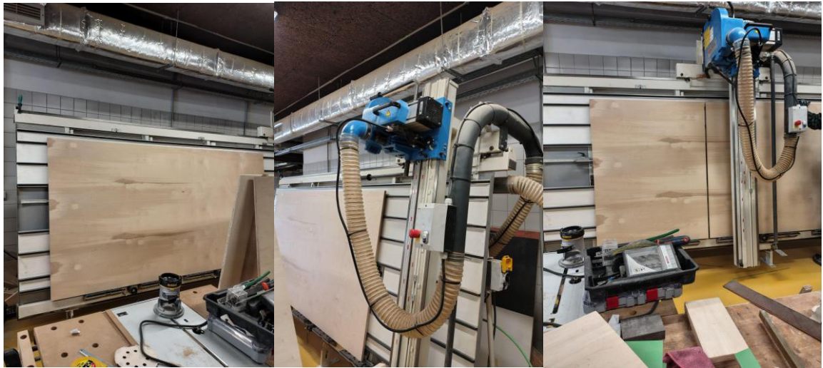
Figura 75 Serra de corte vertical para o corte da chapa de compensado.
