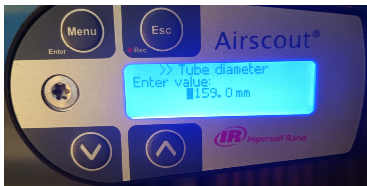
Figura 5.4: Parametrização do valor do diâmetro interno da tubagem do caudalímetro.
