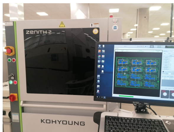
Figura 4.7: Equipamento utilizado na inspeção final do PCB - AOI.
