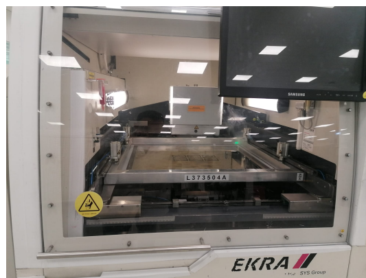
Figura 4.3: Máquina utilizada na passagem de pasta - Printer .
