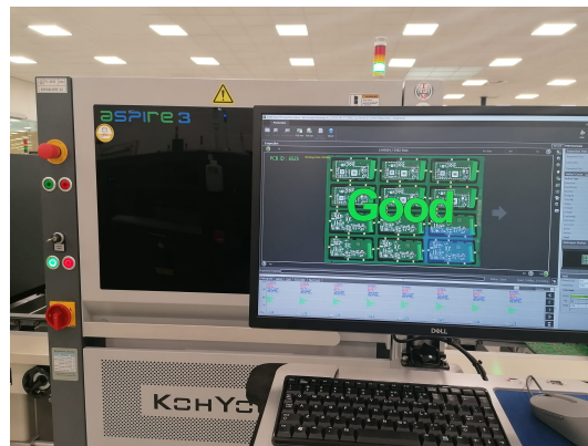
Figura 4.4: Dispositivo utilizado na inspeção da pasta - SPI.
