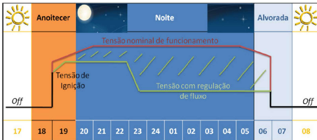
Figura 39 Regulador de Fluxo Luminoso período noturno [38]
