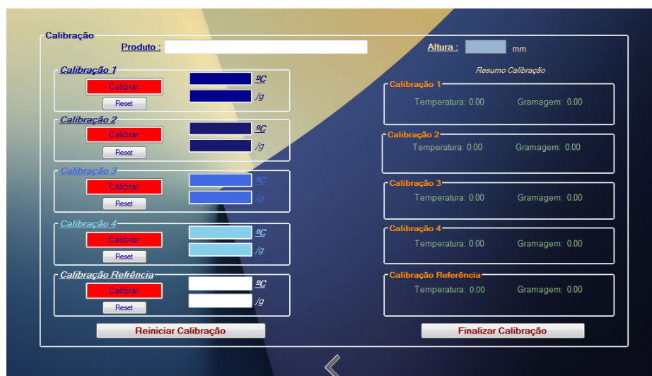
Figura 5.3: Calibração para um novo produto na interface gráfica do Ink Control System
