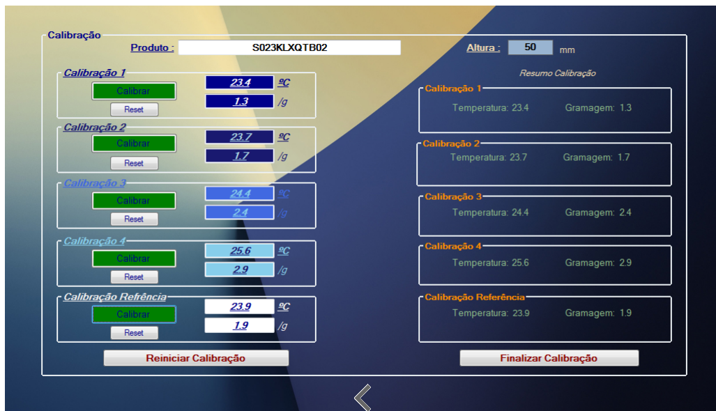
Figura 5.4: Exemplo de uma calibração para um novo produto na interface gráfica do Ink Control System
