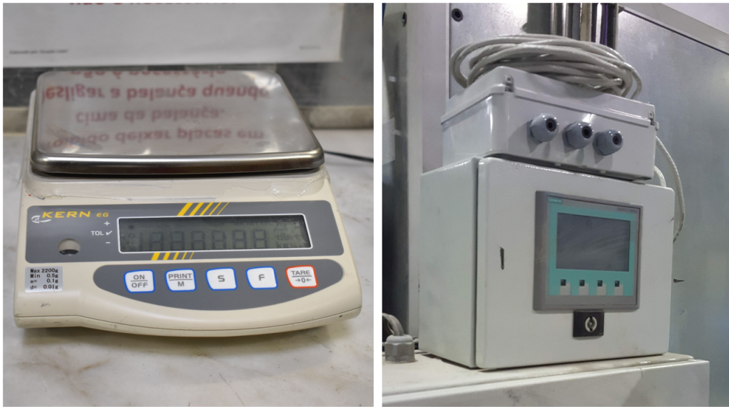
Figura 3.5: Balança e HMI do sistema implementado
