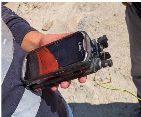
Figura 31- Ordenador de detonadores eletrónicos.
