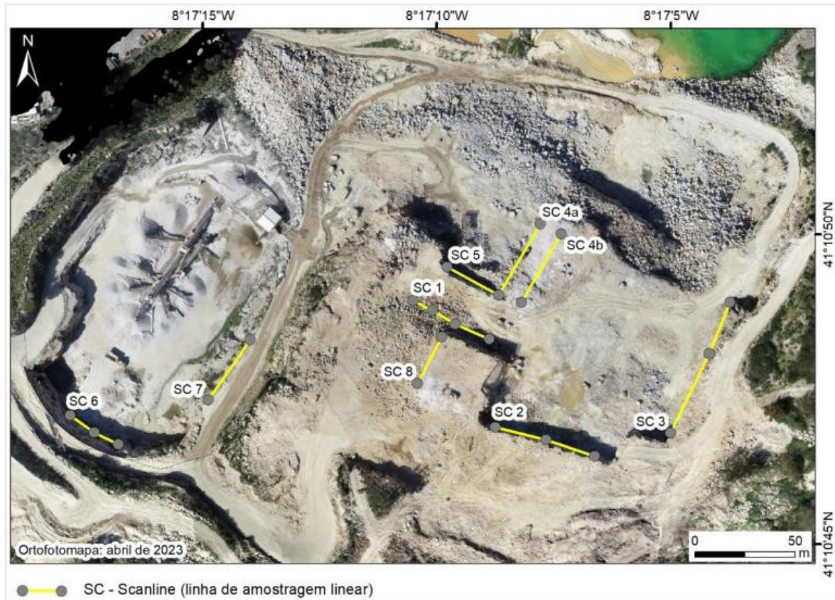
Figura 40- Ortofotomapa de pormenor para desenvolvimento de um esboço cartográfico de zonamento geotécnico com a localização das diferentes ‘scanlines’ aplicadas para o levantamento dos parâmetros geológico-geotécnicos, captada em abril de 2023 (adaptado de Guedes, 2024).
