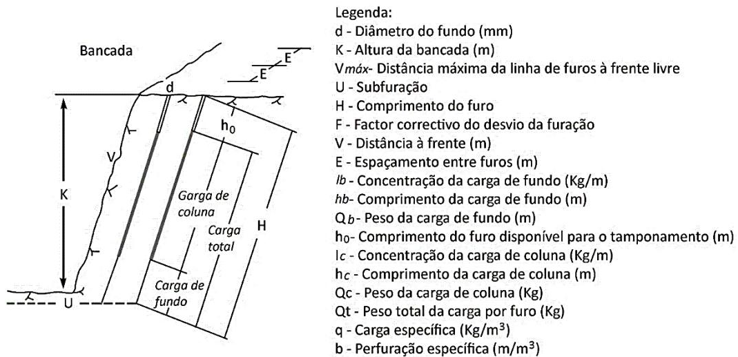
Figura 15- Síntese de parâmetros de um diagrama de fogo (adaptado de Gomes et al, 2007).
