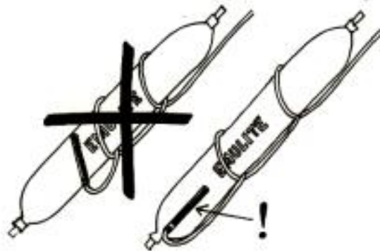
Figura 21– O detonador deve ser colocado no cartucho com a parte explosiva orientada no sentido da detonação (adaptado de Gomes et al, 2007).
