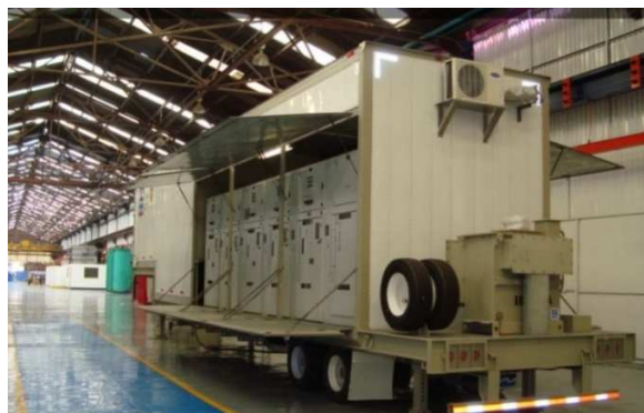
Figura 1.5. Módulo de Celas de Média Tensão [11].
