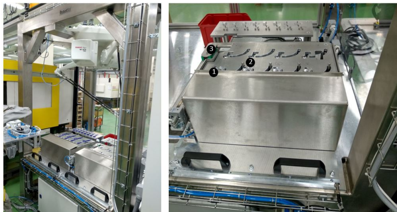
Figura 5.11: Lado esquerdo: na parte superior da estrutura encontra-se o robô encarregue pela montagem e por baixo as bases de montagem. Lado direito: base de montagem: 1 - guias cilíndricas para a peça quando é pousada, 2 - pinos que realizam o fecho das peças, 3 - empurrador para empurrar as peças produzidas para a caixa que se encontra debaixo da estrutura.
