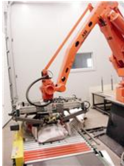
Figura 4.13: O robô executa a operação de pegar num saco de feijões no transportador. Pode verificar-se também a estrutura do seu atuador final, que permite esta tarefa [52].
