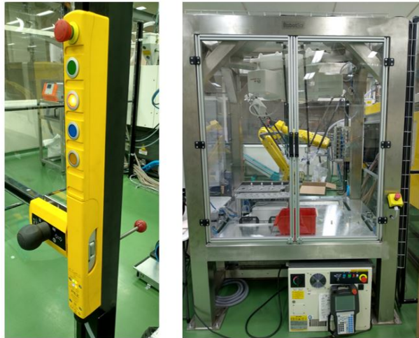
Figura 5.13: Na imagem do lado esquerdo encontra-se a PSENsgate e do lado direito as portas de acesso à estrutura de montagem.
