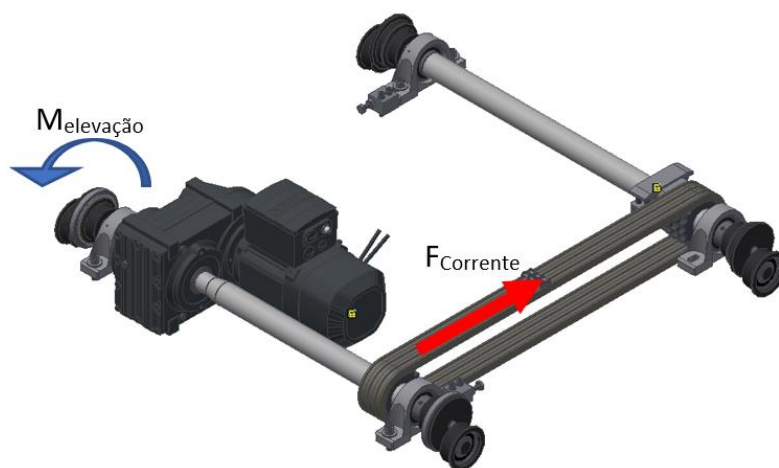
Figura 85 - Acionamento do sistema de elevação.
