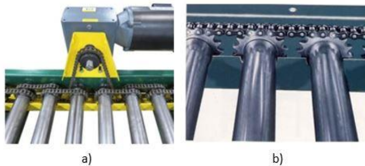
Figura 21 - Tipos de acionamento por corrente em transportadores de rolos. Adaptado de [39]
